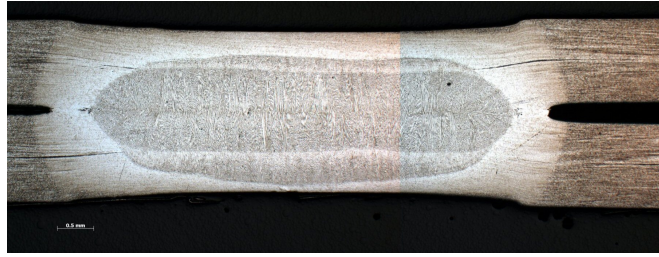
Figure II-5 Vue macroscopique d'une coupe métallographique d'un point soudé en cycle pulsé avec 2 trains d'onde, après attaque Béchet-Beaujard. Les limites de la zone fondue après chaque pulse apparaissent très clairement
