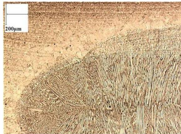
**Figure II-7** Zone fondue et GGZAT d'un point soudé après attaque Béchet-Beaujard. La structure de solidification est nettement révélée par une oxydation préférentielle des ségrégations interdendritiques
