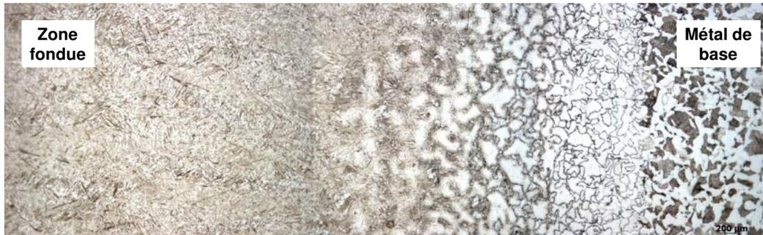
Figure IV-4 Vue transversale de la soudure laser après attaque Nital
