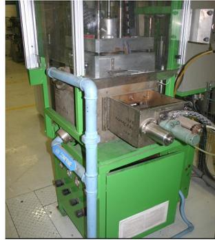
Figure IV-7 Photographie du four de recuit continu
