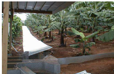
Figure 2-8 Dispositif de suivi hydrologique sur la parcelle Espérance Haut (d'après Cattan et al. (2006)) – en photo : le dispositif de mesure de débit et le canal collecteur.
