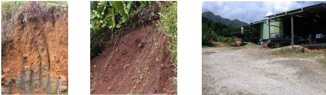
Figure 2-11 Photographies de gauche à droite : un andosol, un ferralsol, un hangar agricole et sa plateforme.
