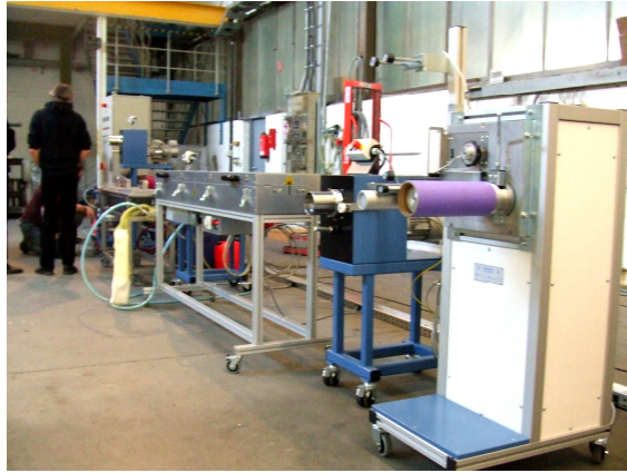
Figure 22 : ligne développée par Fourné (Allemagne) et installée au CRPP depuis juin 2006, pour le filage pilote des nanotubes de carbone
