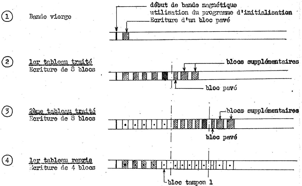
Le bloc tampon 1 est devenu illisible et risque d'avoir été dédoublé. On passe du tableau 1 au tableau 2 par saut avant de deux blocs par-dessus le bloc tampon.
