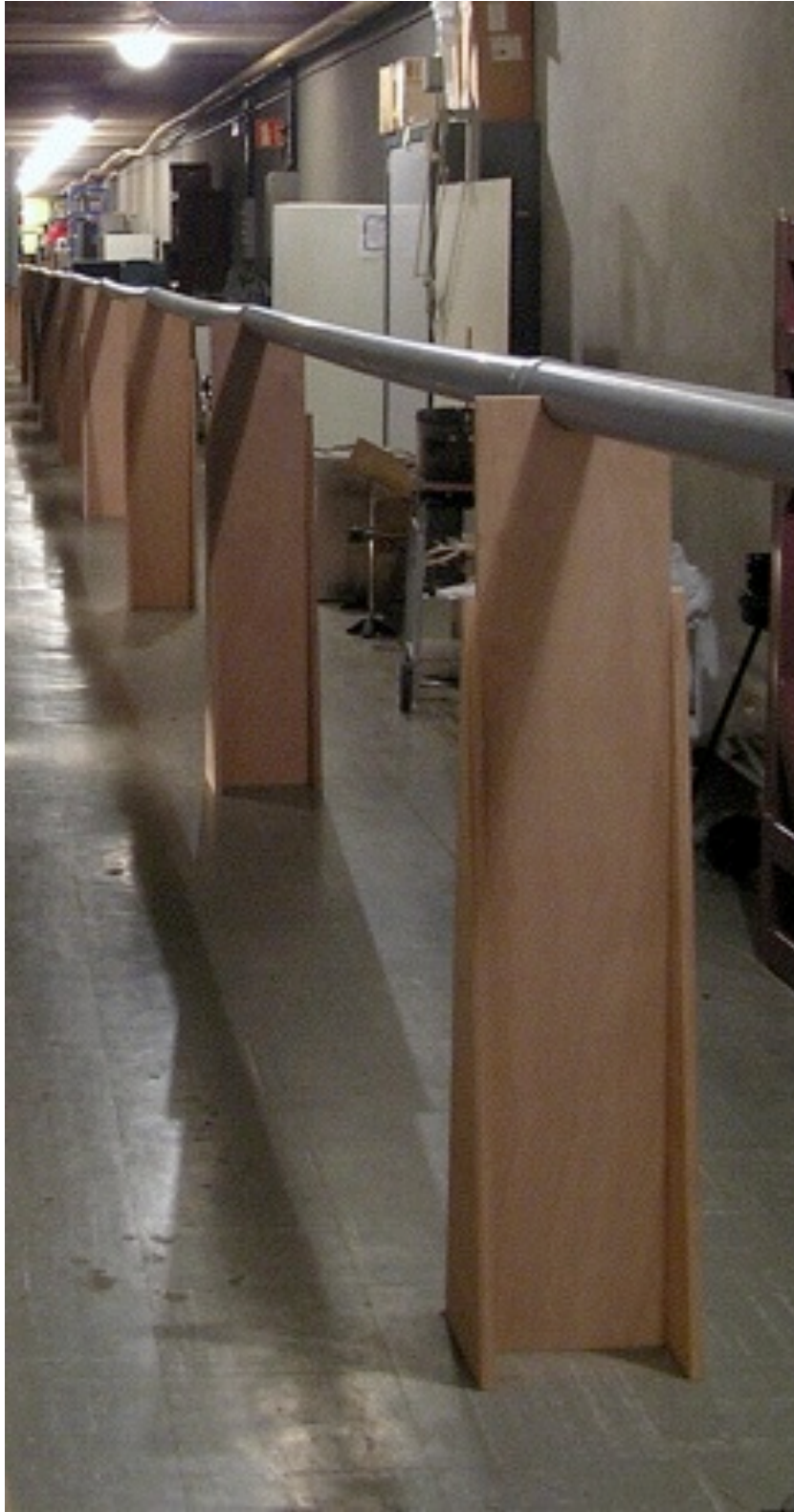
FIG. 3.1 – Expérience d'interférence à un photon en régime de choix retardé réalisée dans le sous-sol de l'ancien bâtiment de l'Institut d'Optique, sur le campus d'Orsay.
