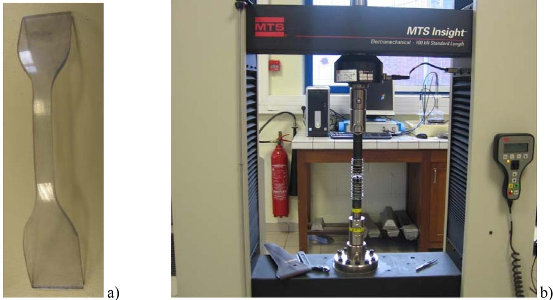
Figure 3.18 a) Eprouvette de PVC plastifié.
