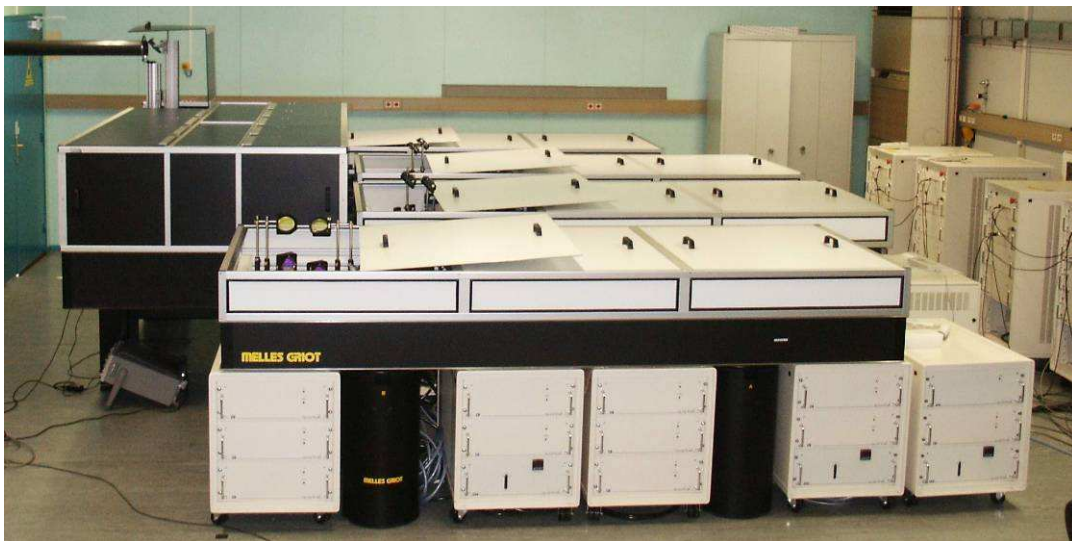
Figure 1.27 : Implantation des 4 tables laser QUANTEL et de la table optique du dernier amplificateur haute énergie.
