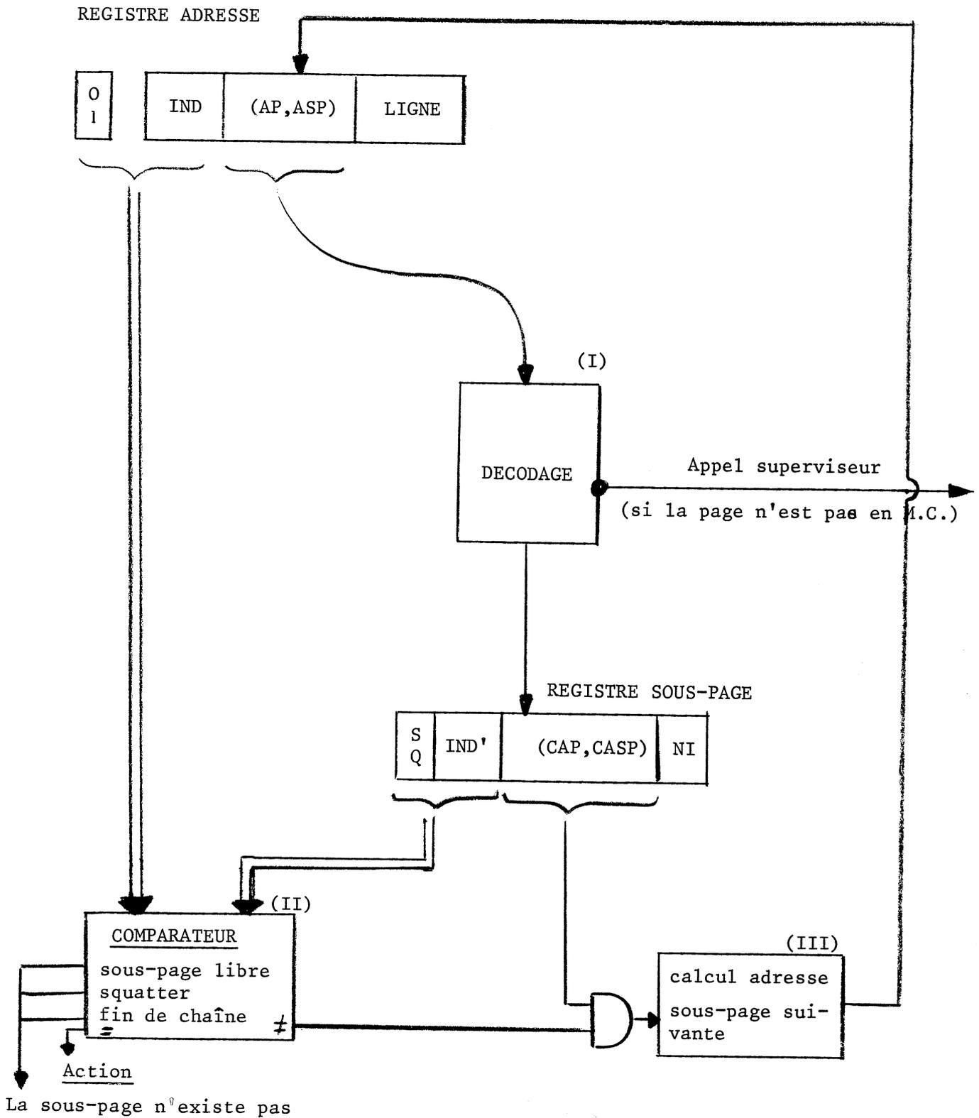
Ce schéma montre les trois fonctions de base qu'il faut réaliser pour déterminer une adresse réelle correspondant à une adresse virtuelle X.
