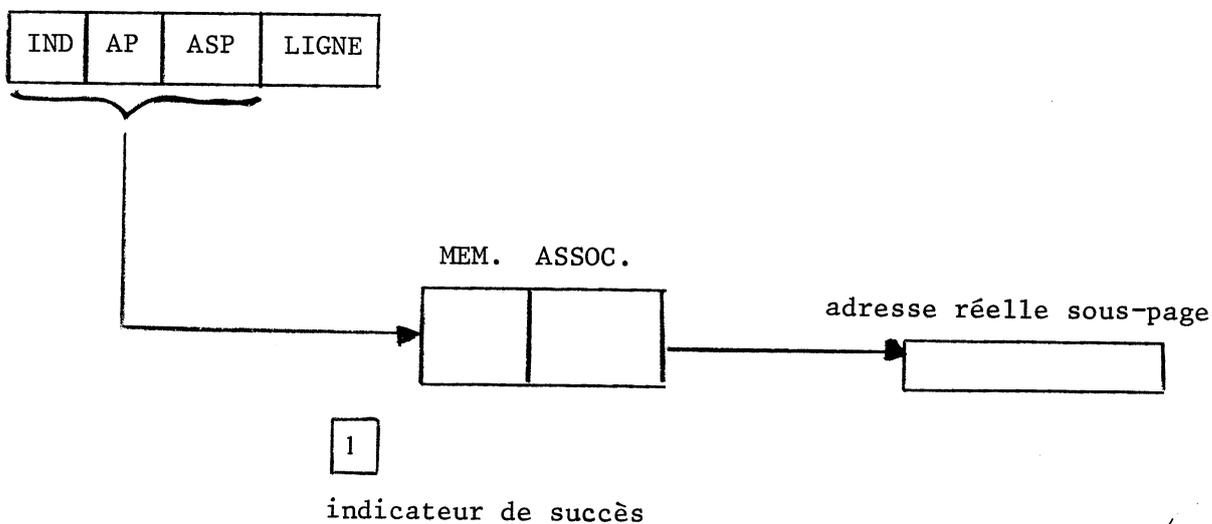
Cette technique peut également être utilisée au niveau de la recherche d'une page en mémoire centrale.
