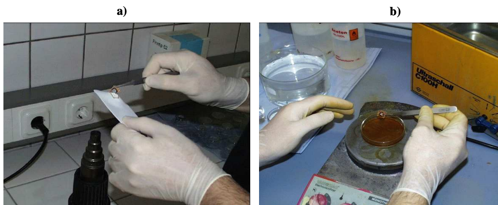
Fig. 3.a) Extraction de la puce, b) Traitement de la couche de passivation
