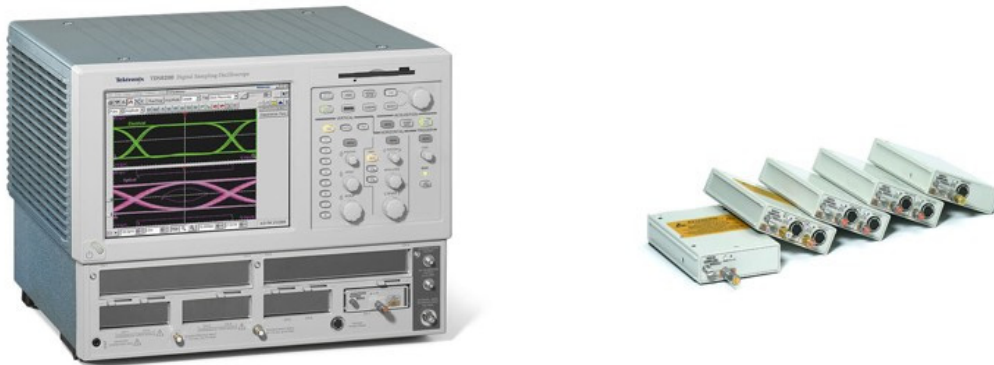
Figure 2.11 - Oscilloscope TDS8200 et module TDR permettant de générer un échelon avec un temps de montée rapide ( \approx 35ps ).
