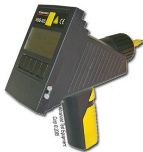
Figure 1.17 – Pistolet ESD reproduisant la décharge d'un corps humain sur un système.
