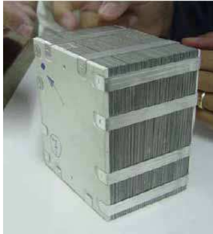
FIG. 3.12 – Emballage mécanique des briques d'OPERA.
