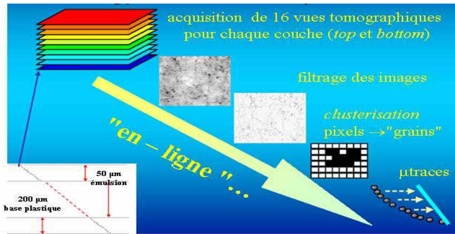
FIG. 4.3 – Schéma des différentes étapes de la reconstruction de traces avec le Système de Scan Européen.
