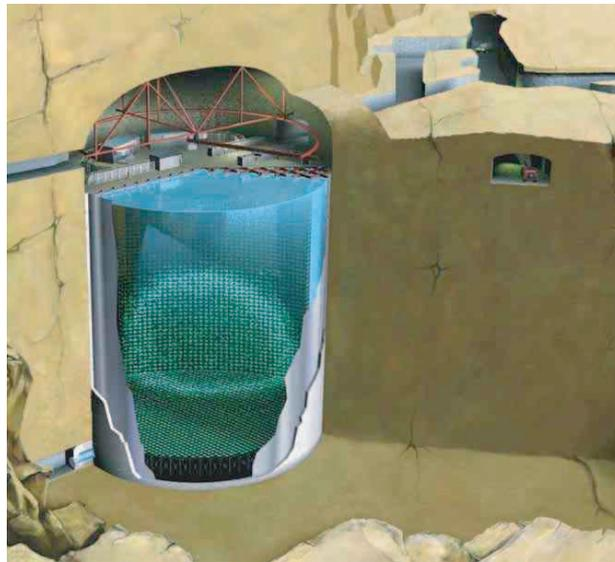
FIG. 2.7 – Vue schématique du détecteur Super-Kamiokande.
