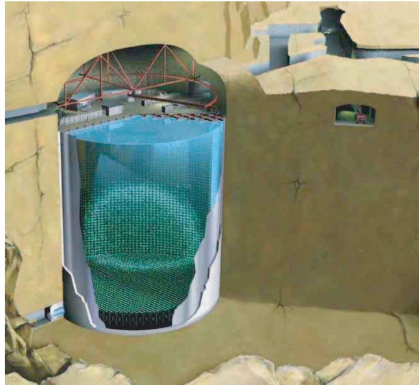
FIG. 2.7 – Vue schématique du détecteur Super-Kamiokande.
