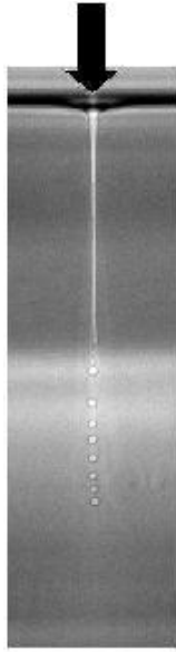
FIG. 3.21 – Jet liquide induit par la pression de radiation d'un faisceau laser à l'interface entre deux fluides : le laser arrive par le haut (flèche noire). Le jet émet des gouttes de façon continue. Le champ de l'image est de 250\mu\text{m} de large sur 800\mu\text{m} de haut. [6]
