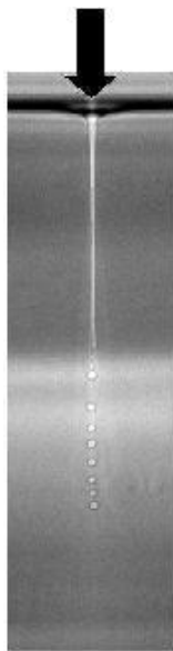
FIG. 8.23 – Jet liquide induit par la pression de radiation d’un faisceau laser à l’interface entre deux fluides : le laser arrive par le haut (flèche noire). Le jet émet des gouttes de façon continue. Le champ de l’image est de 250\mu\text{m} de large sur 800\mu\text{m} de haut.
