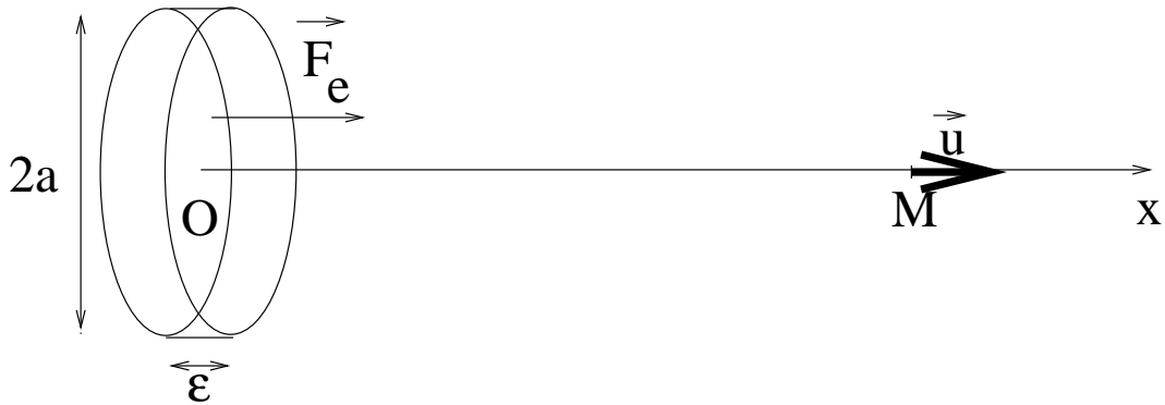
FIG. 2.11 – Vitesse créée au sein d'un fluide par une force appliquée de façon uniforme sur un élément de volume cylindrique de rayon a et d'épaisseur \epsilon
