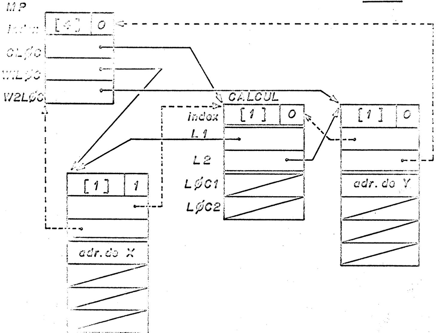
Le passage de contrôle entre les différentes unités pour les initialisations est représenté par le diagramme suivant, à partir de l'état donné dans la figure F21.
