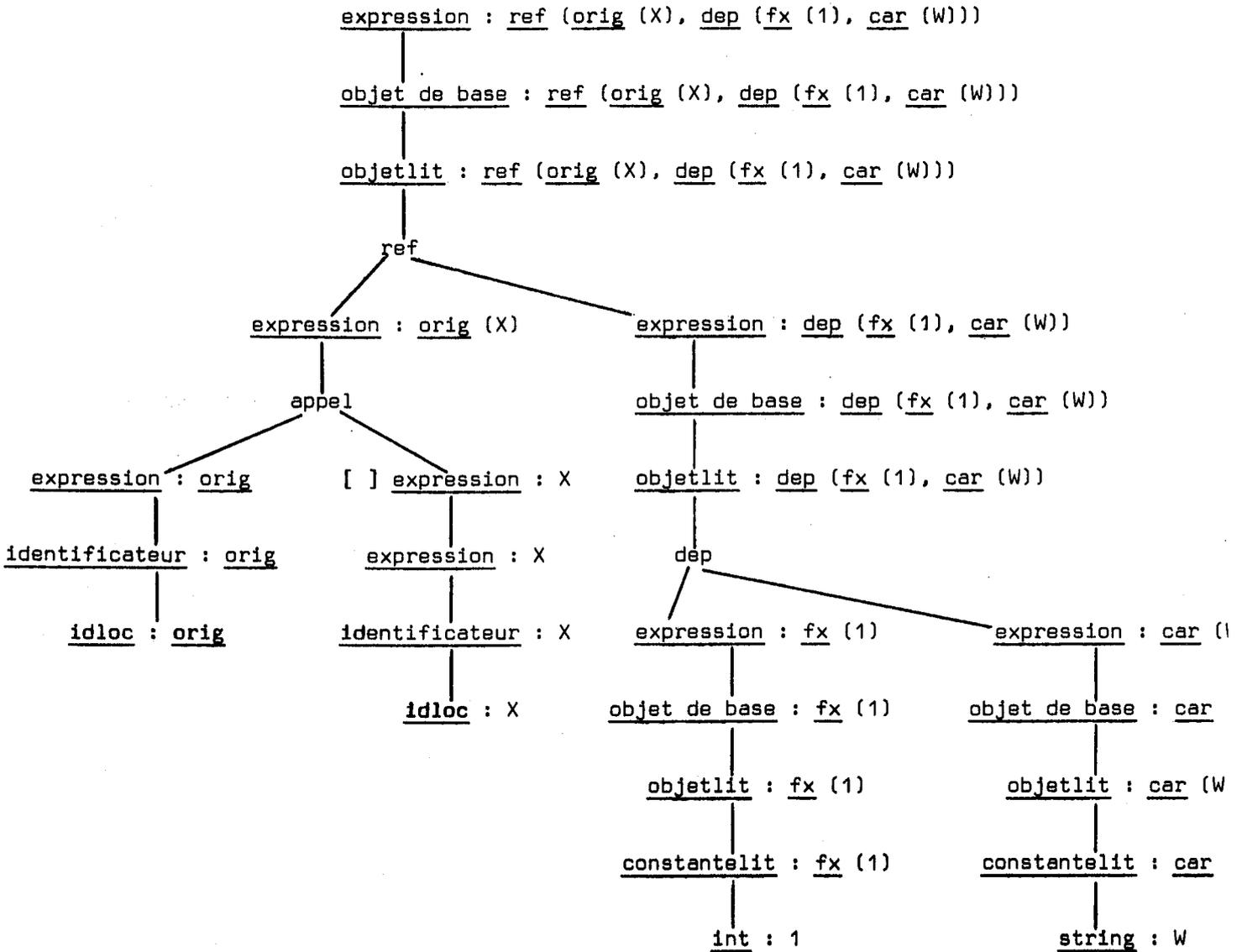
L'évaluation de l'arbre abstrait se fait en appliquant la procédure eval en haut de l'arbre et en développant les appels de procédure d'après des modes rencontrés. On fait le développement des appels en parallèle pour mieux suivre le déroulement dans l'arbre :
