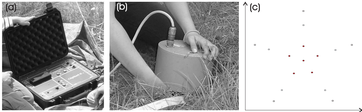
FIG. 2.2 – Descriptif du matériel d'acquisition du bruit de fond sismique, (a) Cityshark II, (b) capteur Lennartz 5s, (c) Dispositif optimal d'acquisition du bruit de fond réseau
