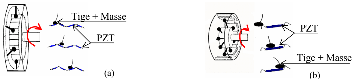
Fig. I.21 : Dispositifs rotatifs fonctionnant en régime dynamique [ATS 02]
