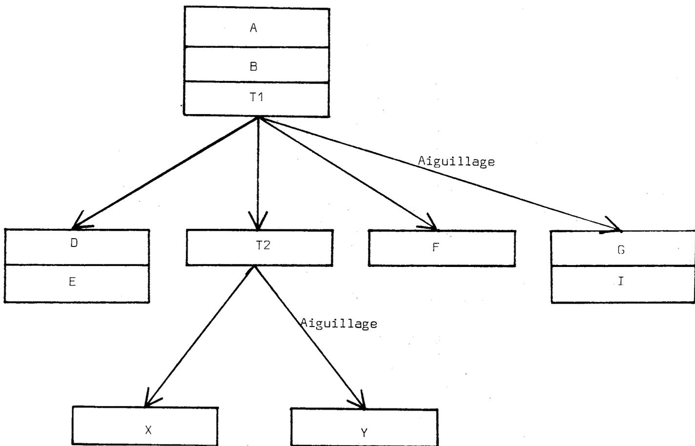
Figure II.1. Exemple de structure logique de 'record'
