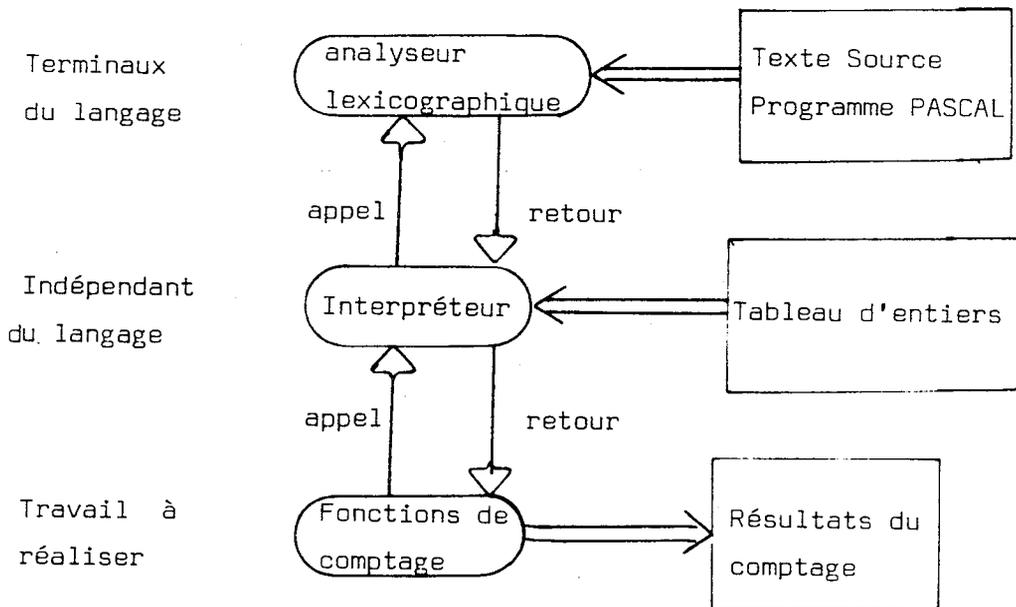
Le module interpréteur est complètement indépendant du langage et du travail à réaliser, il se contente de vérifier la syntaxe spécifiée dans le tableau d'entiers. Le module analyseur lexicographique est dépendant des terminaux du langage, mais indépendant du travail à effectuer. Il fournit l'unité syntaxique suivante (codée). Le module fonction contient les algorithmes des fonctions insérées dans la grammaire.
