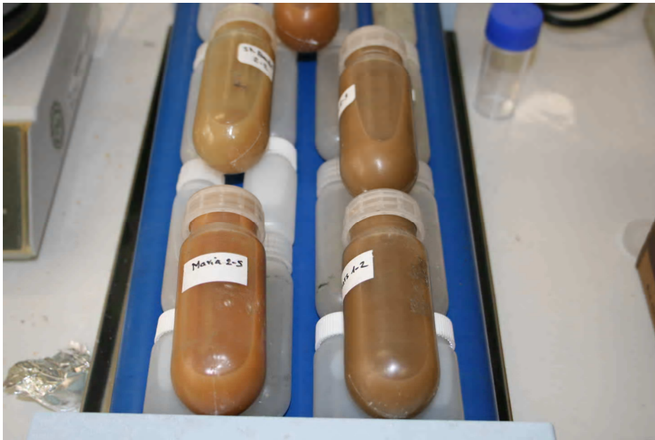
Figure 3 : Agitation mécanique (12 h) de la suspension des fractions argileuses après avoir ajouté de 50 ml de MgCl_2 .
