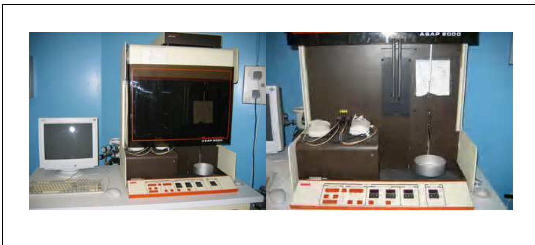
Figure 2.5 : Photographie montrant le dispositif utilisé pour mesurer la surface spécifique BET (Analyseur de surface).
