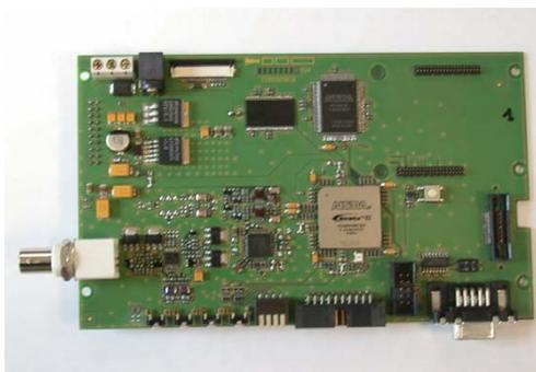
FIG. 4.19: Modem CPL sur FPGA
