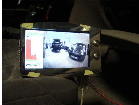
FIG. 4.22: Réception de la vidéo et affichage du spectre
