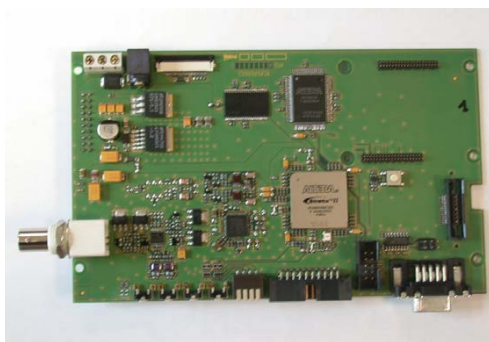
FIG. 4.19: Modem CPL sur FPGA
