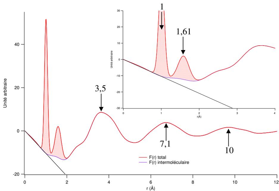
figure 27 : Fonction  $F(r) = r(g_m(r)-1)$ . Les deux pics étroits à 1,00 Å et 1,61 Å correspondent respectivement aux distances ND et DD intramoléculaires. On note qu'il subsiste une intensité très importante entre 1,2 et 2 Å.
