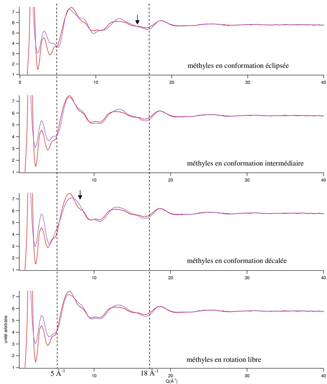
figure 49 : Spectre expérimental (en rouge) et simulation du facteur de structure de la NMA en configuration *trans* (en bleu) pour différentes configurations des groupements méthyles. Du haut vers la bas, les méthyles sont en position : éclipsée, intermédiaire, décalée et en rotation libre.
