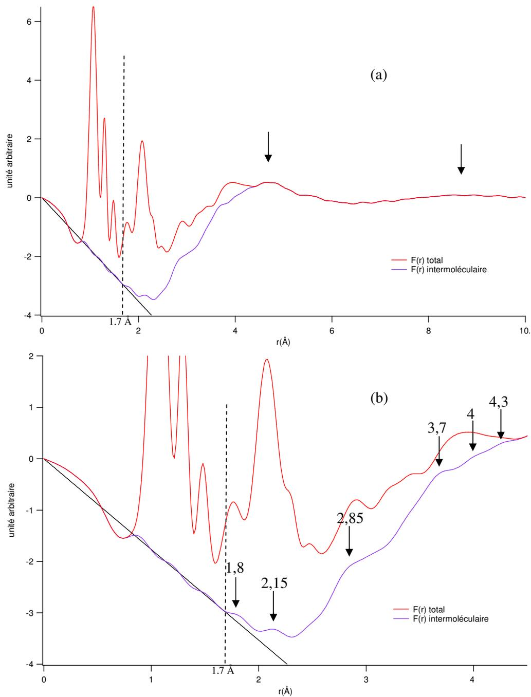
figure 44 : Fonction  $F(r) = r(g_m(r)-1)$  pour  $\varphi = 30^\circ$ . On observe sur la fonction  $F(r)$  intermoléculaire 2 épaulements indiqués par des flèches (a) et correspondant à des couches de molécules successives, et 6 épaulements sur l'agrandissement (b) qui correspondent à des paires d'atomes n'appartenant pas à la même molécule.
