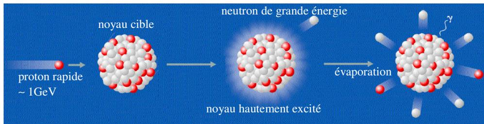
figure 16 : Représentation schématique d'une réaction de spallation.
