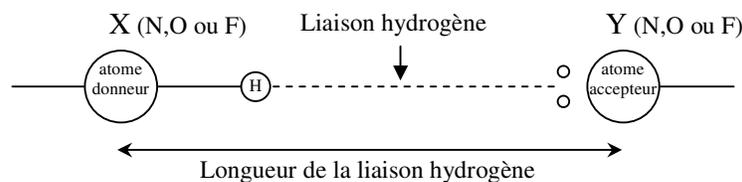
figure 2 : Représentation schématique de la liaison hydrogène.
