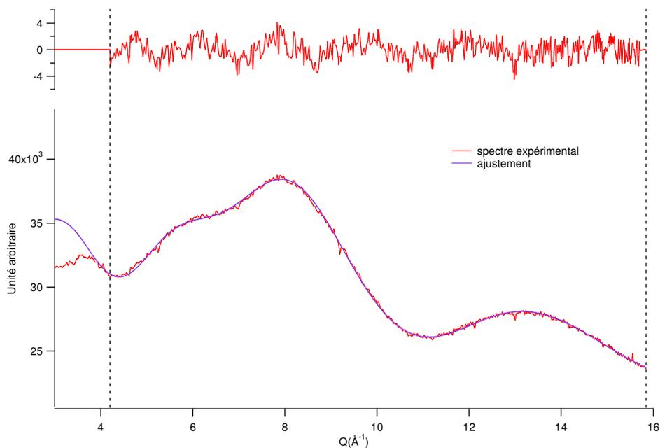
figure 30 : Ajustement du facteur de forme de la molécule, de la liaison hydrogène et des plus proches voisins DD. Le domaine de  $Q$  s'étend de  $4,2$  à  $16 \text{ \AA}^{-1}$ . On note que le résidu est légèrement structuré.
