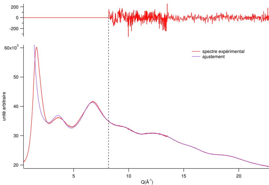
figure 43 : meilleur ajustement obtenu pour la NMF en conformation trans et pour un méthyle modélisé en rotation libre. La valeur de la borne inférieure du domaine d'ajustement est de  $8,2 \text{ \AA}^{-1}$ .
