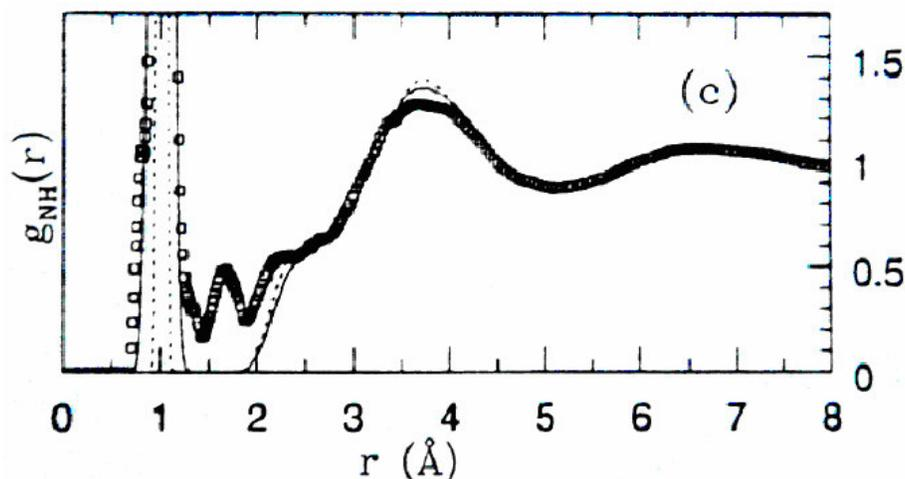
figure 24 : Comparaison entre la fonction de corrélation de paire partielle azote-hydrogène obtenue par simulation *ab initio* (ligne), par simulation empirique (pointillés), et par données expérimentales<sup>(P3)</sup> (carrés). (issue de la référence bibliographique (P5))
