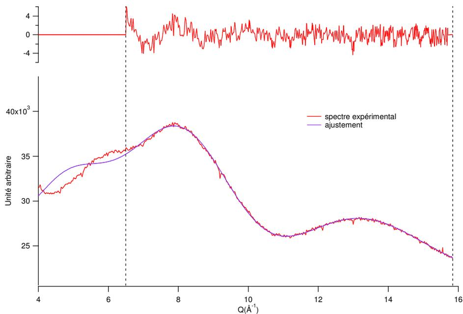
figure 28 : Ajustement de la molécule d'ammoniac plus la liaison hydrogène dans un domaine allant de 6,5 à 16  $\text{\AA}^{-1}$ . L'ajustement n'est pas parfait entre 6,5 et 8  $\text{\AA}^{-1}$ . Le nombre de liaison H a été fixé à 1, valeur qui produit une fonction  $F(r)$  correcte (voir figure 29). La distance moyenne de la liaison H est trouvée à 1,71  $\text{\AA}$ .
