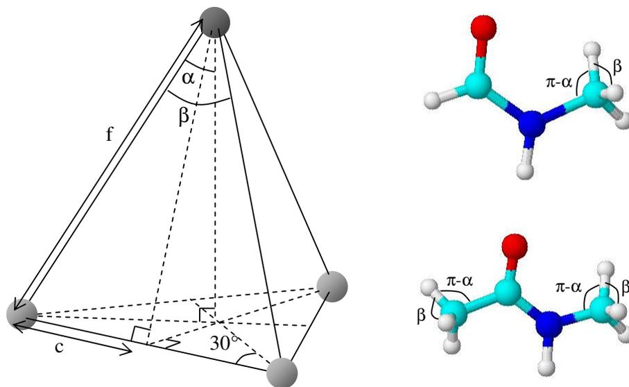
figure 20 : pyramide trigonale modélisant les groupements méthyles de la NMF et de la NMA. La symétrie C<sub>3v</sub> étant imposée, les seuls paramètres de longueurs nécessaires sont c et f.
