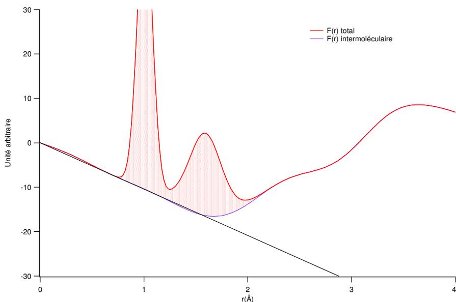
figure 29 : Fonction  $F(r)$ . Par comparaison avec la figure 27 on s'aperçoit que l'intensité additionnelle trouvée entre 1,2 et 2  $\text{\AA}$  est correctement prise en compte par l'introduction d'une distance N-D de 1,71  $\text{\AA}$ .
