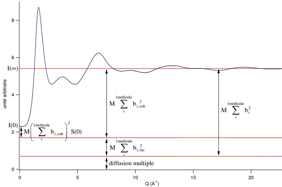
figure 18 : Schéma d'un spectre (corrigé du bruit de fond et de l'inélasticité) de liquide moléculaire par diffusion de neutron. Le facteur  $M$  est proportionnel au nombre de molécules éclairées et au nombre de neutrons diffusés.  $S(0) = \rho_m k_B T \chi_T$  (voir chapitre 2 paragraphe 10).  $I(0)$  et  $I(\infty)$  sont les intensités respectivement à  $Q = 0$  et  $Q = \infty$ .
