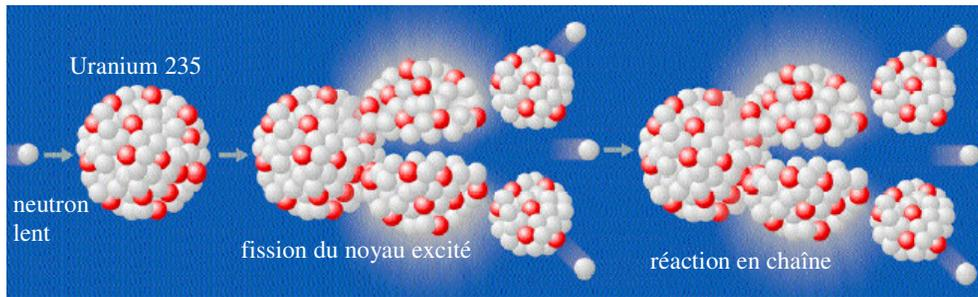
figure 10 : Représentation schématique d'une réaction de fission.
