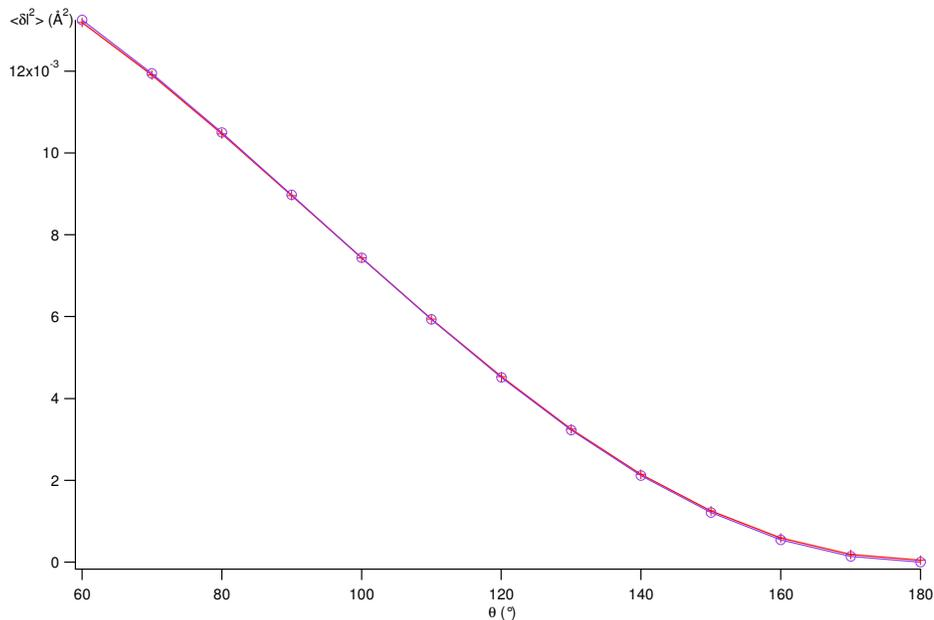
figure 53 : Evolution de  $\langle \delta l^2 \rangle$  en fonction de  $\theta$  (pour  $a = 1 \text{ Å}$ ,  $b = 1,2 \text{ Å}$ )
