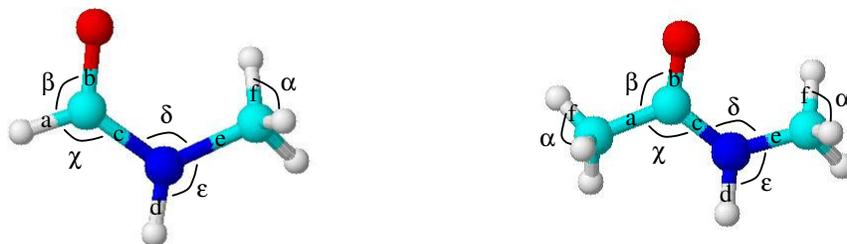
figure 19 : Représentations des molécules de NMF ( $\text{HCO-NH-CH}_3$ ) et de NMA ( $\text{CH}_3\text{-CO-NH-CH}_3$ ), et des distances et angles permettant de calculer toutes les distances intramoléculaires. Les distances indépendantes sont indiquées par les lettres de a à f, et les angles indépendants par les lettres grecques de  $\alpha$  à  $\varepsilon$ .
