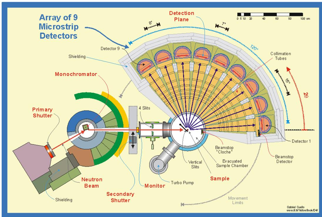
figure 14 : schéma général du diffractomètre D4 version C. (vue du dessus)
