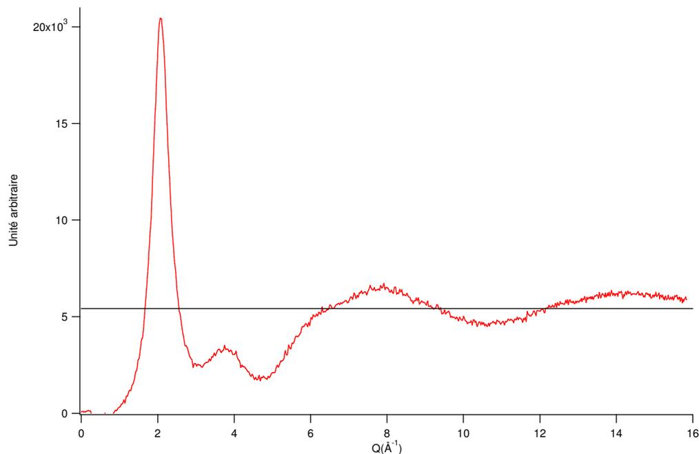
figure 33 : Spectre différence  $^{14}\text{ND}_3 - ^{15}\text{ND}_3$ .
