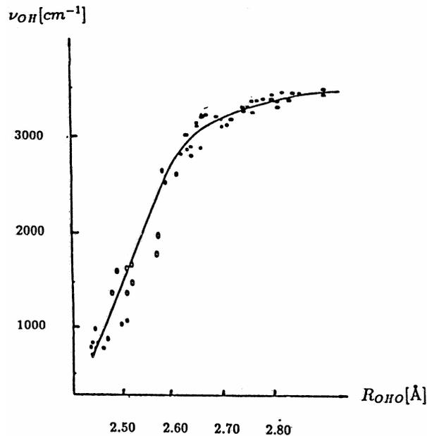
figure 3 : Résultats expérimentaux reliant la fréquence de vibration de la liaison O-H à la distance O...O.
