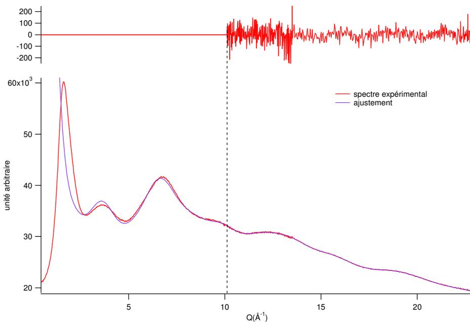
figure 42 : meilleur ajustement obtenu pour la NMF en conformation trans et pour un méthyle dit « décalé » ( $\varphi = 30^\circ$ ). La valeur de la borne inférieure du domaine d'ajustement est de  $10,1 \text{ \AA}^{-1}$ .
