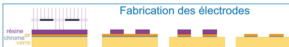
FIG. A.2: Fabrication des électrodes
