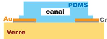
FIG. 5.2: Schéma en coupe du système microfluidique.
