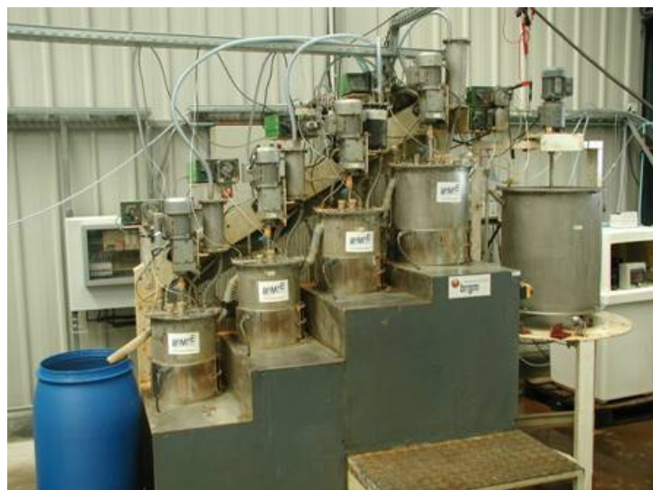
Figure II-6 : Unité de biolixiviation du pilote continu (BRGM).
