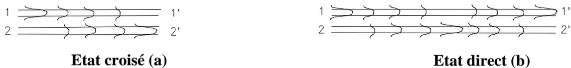
**Figure 47 : Schéma des deux états extrêmes d'un coupleur**
