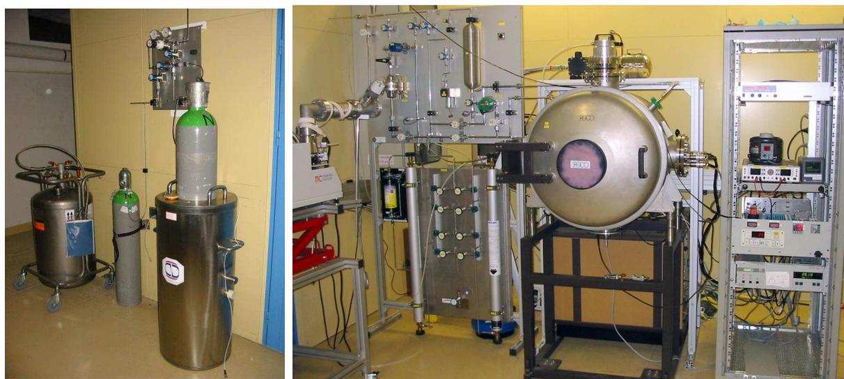
FIG. 3.7 – Bouteille de récupération du xénon (à gauche) et une vue globale du dispositif cryogénique
