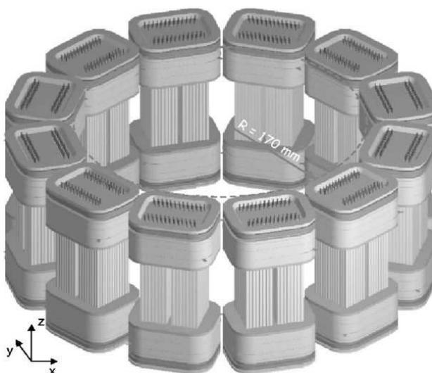
FIG. 2.15 – La géométrie de la caméra TEP utilisant le partage de la lumière [6, 7]
