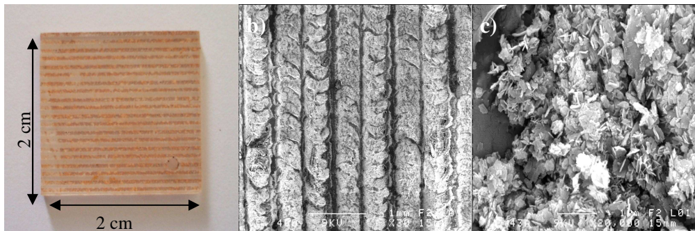
Figure 5 : Support recouvert de lépidocrocite pure, a) stries incrustées d'oxydes, b) photographie au microscope électronique à balayage (MEB) de stries incrustées de lépidocrocite, c) écaillés de lépidocrocite dans les stries du support.
