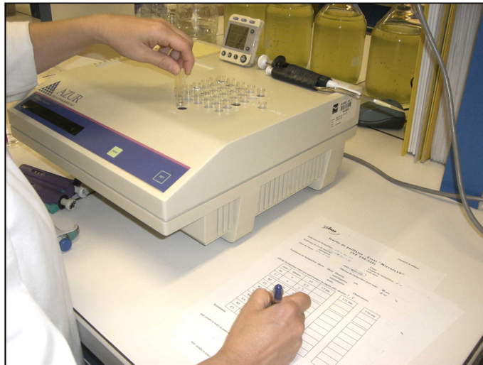
Figure 17 : Dispositif expérimental de l'essai microtox
