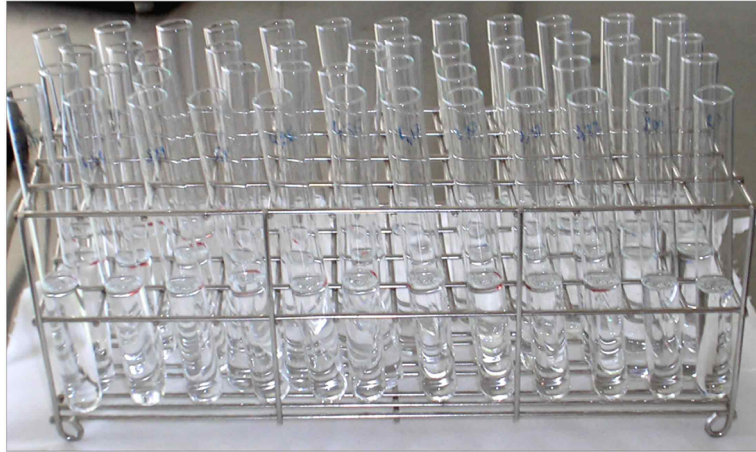
Figure 15 : Dispositif expérimental de l'essai Daphnia magna
