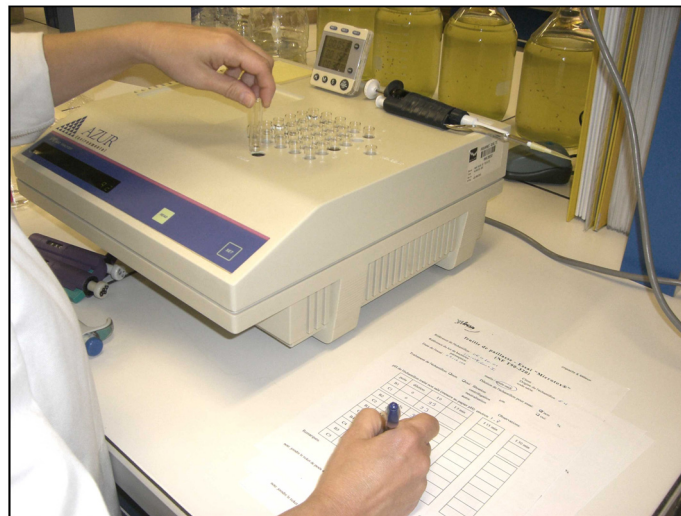
Figure 17 : Dispositif expérimental de l'essai microtox
