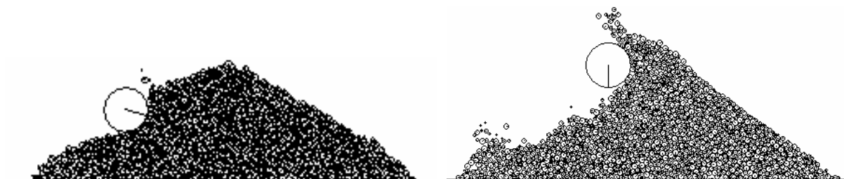
Figure 1.41 Influence de la vitesse d'impact pour un impact horizontal : vitesse V = 5m/s (à gauche) et V = 20m/s (à droite), d'après Lachapelle 2003.
