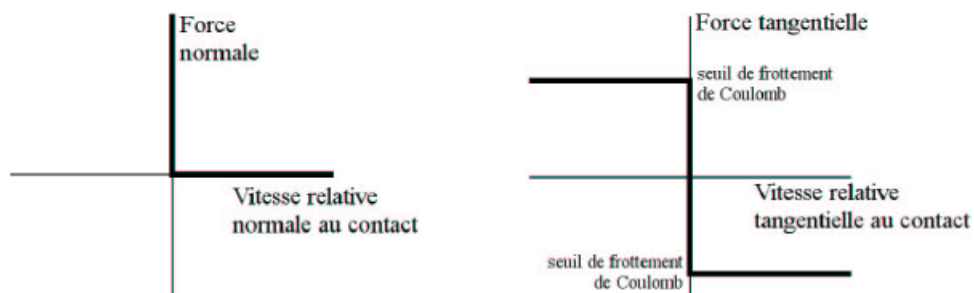
Figure 2.1 Condition de Signorini entre vitesses et efforts régissant la mécanique d'un contact normal (à gauche) et tangentiel (à droite) dans le cadre de la dynamique des contact.
