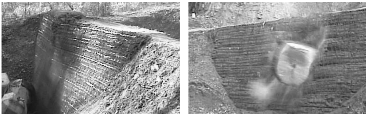
Figure 1.32 Destruction du merlon dès le premier impact, vue de trois quarts du parement aval (à gauche). Cas d'un merlon subissant un deuxième impact (à droite), d'après Castiglia et al. 2002.
