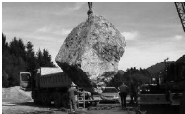
Figure 1.22 Configuration d'essai expérimental d'impact en milieu granulaire pour des énergies élevées, d'après Pichler 2003.
