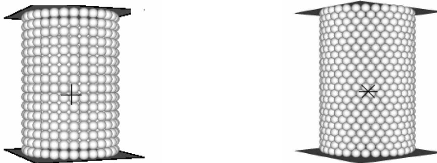
Figure 3.5 Modélisations tridimensionnelles de l'essai triaxial de révolution avec membrane latérale flexible, d'après Salot 2004. Exemples de maillage carré (à gauche) ou hexagonal (à droite) de la membrane.
