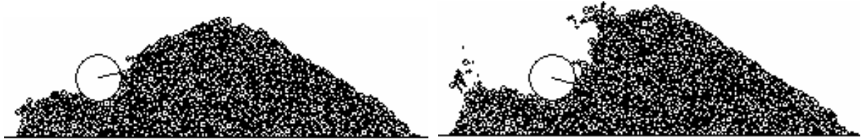
Figure 1.42 Influence de la vitesse d'impact pour un impact orthogonal au parement amont : vitesse V = 5m/s (à gauche) et V = 20m/s (à droite), d'après Lachapelle 2003.
