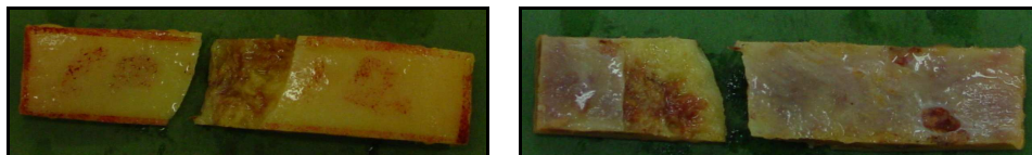
Figure 2-28 : Rupture diffuse de l'éprouvette
