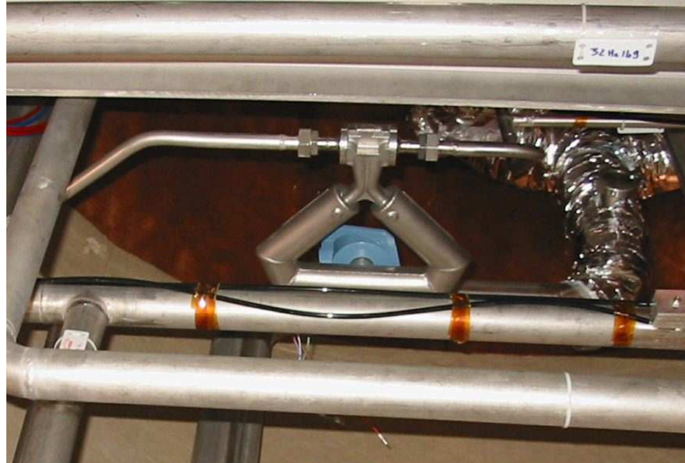
FIG. 5.3 – Le débitmètre Coriolis utilisé pour mesurer le débit total d'hélium liquide injecté.
