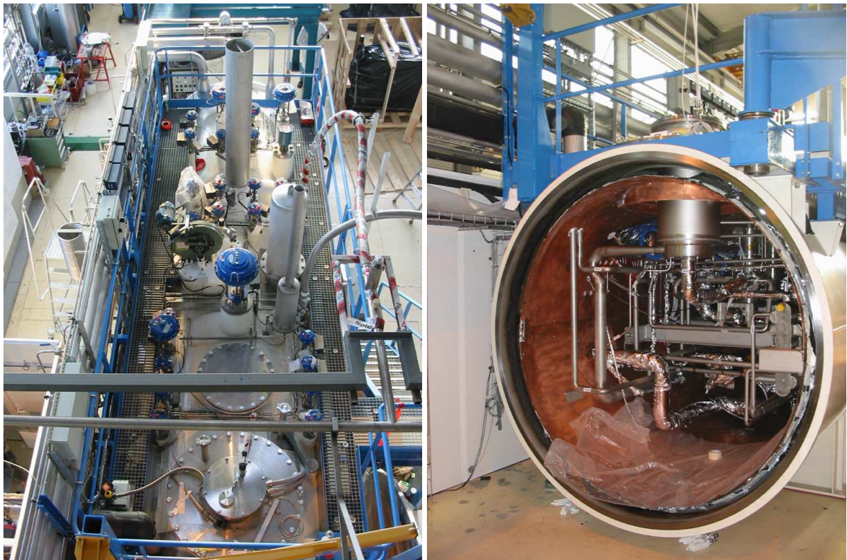
FIG. 4.1 – Station d'essais 400W@1.8K . A gauche, vue de dessus de l'enceinte contenant la partie froide de la station de réfrigération, dite boîte froide . A droite, vue de la boîte froide ouverte. Les parties massives correspondent aux échangeurs de chaleur. L'expérience Cryoloop se situe sur la gauche de la figure : on distingue la cloison de la cahute (érigée pour raisons de sécurité laser) renfermant les principaux appareils de mesure. Les tubes sortants contiennent l'alimentation en hélium de l'expérience et une circulation d'azote liquide. Le retour en hélium diphasique se fait par le tube principal au centre.
