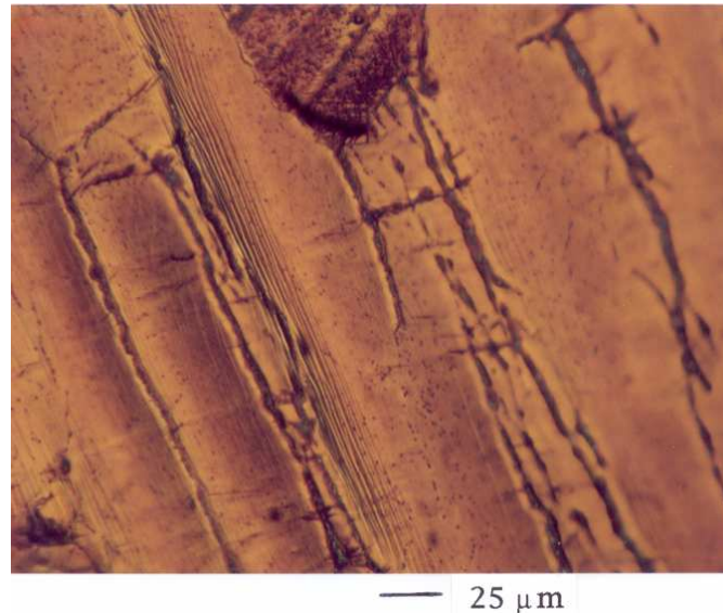
Figure 14a) Mise en évidence au moyen de la technique d'oxydation ménagée d'un gradient de composition chimique en oxygène au sein des lamelles de zirconium. Localisation du glissement prismatique le long des joints de lattes dans les zones appauvries en éléments d'addition alphas. [Crépin, 95]
