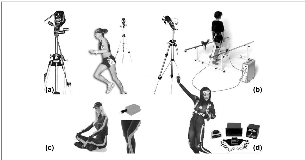
Fig. 1.5 - Systèmes d'analyse tridimensionnelle : (a) optique (Vicon, Oxford, UK), (b) ultrasonique (Zebris, Tuebingen, Allemagne), (c) inertielle (xSens, Enschede, Netherlands) et (d) électromagnétique (Ascension, Burlington, USA).
