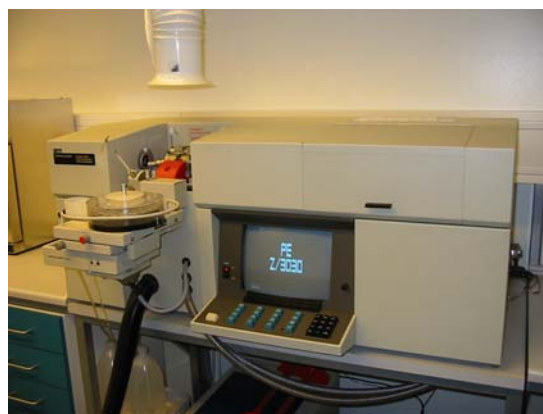
Figure 10 : Spectromètre d'absorption atomique Perkin-Elmer Zeeman modèle 3030 avec autoéchantillonneur
