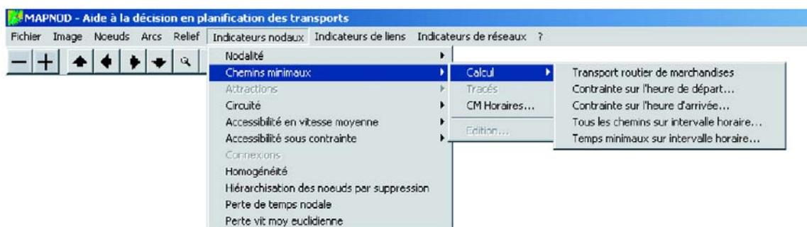
**Figure 40 : Lancement du calcul des chemins minimaux**
