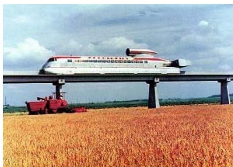
Figure 2 : l'Aérotrain, le I80-HV, accueillant 80 passagers<sup>148</sup>.
