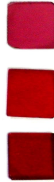
FIGURE 3.1 – Echantillons de verre dopé à l'or (de haut en bas, du moins recuit au plus recuit).
