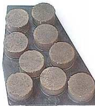
Figure 20 : garniture de frein à disque en matériau fritté pour TGV
