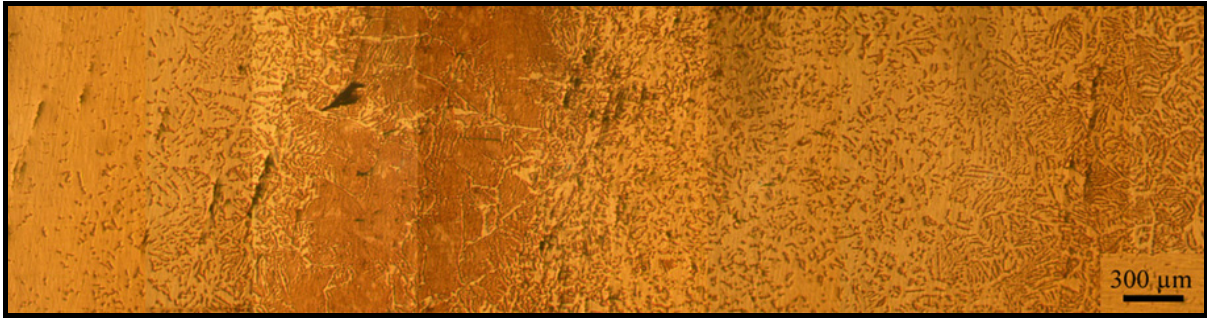
Figure 63 : Micrographie de l'échantillon ROU 314a, attaque Nital.
