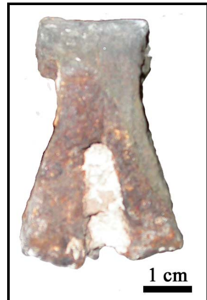
Figure 228 : Agrafes des balustrades du comble bas du chœur de l'église Saint-Jean, côté sud. En haut à gauche, agrafe H3 ; en haut à droite, agrafes H4 et V1 ; en bas à gauche, agrafes de la première travée : H6 et V2 à V6 ; en bas à droite, exemple de patte d'agrafe fendue.
