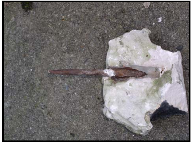
Figure 130 : A gauche goujon OUEN 08 à la base d'un pinacle disparu dans le chéneau du transept nord de l'église Saint-Ouen. A droite, goujon OUEN 04 au sommet d'un fleuron déposé provenant d'une purge.
