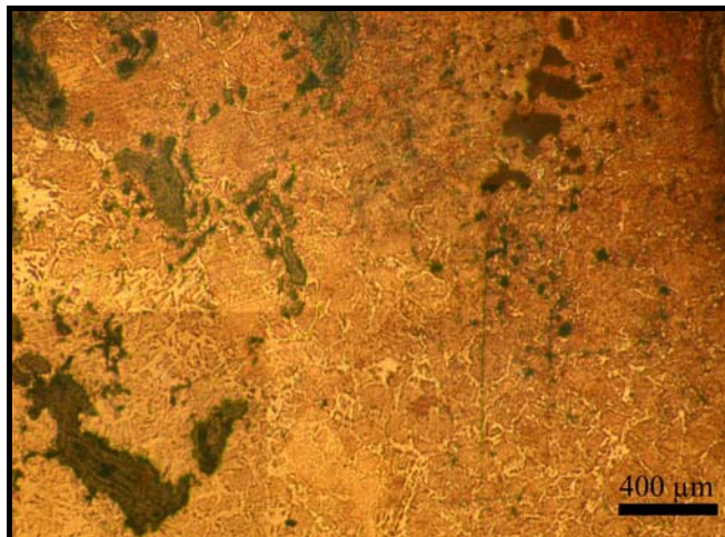
Figure 135 : Pointe de la section OUEN 04a, attaque Nital.
