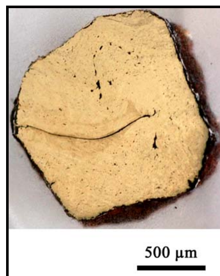
Figure 123 : Fissure due à une mauvaise soudure et alignements d'inclusions, échantillon OUEN13b.
