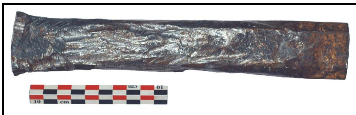
Figure 279 : Goujon d'une statue de la façade de la cathédrale de Reims.
