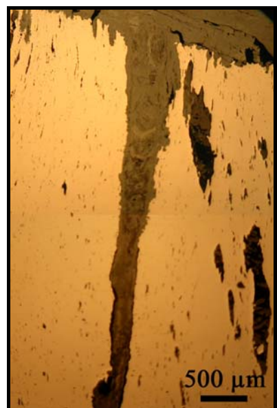
Figure 210 : Soudure et zone de mauvaise propreté inclusionnaire, section TROY 13a.
