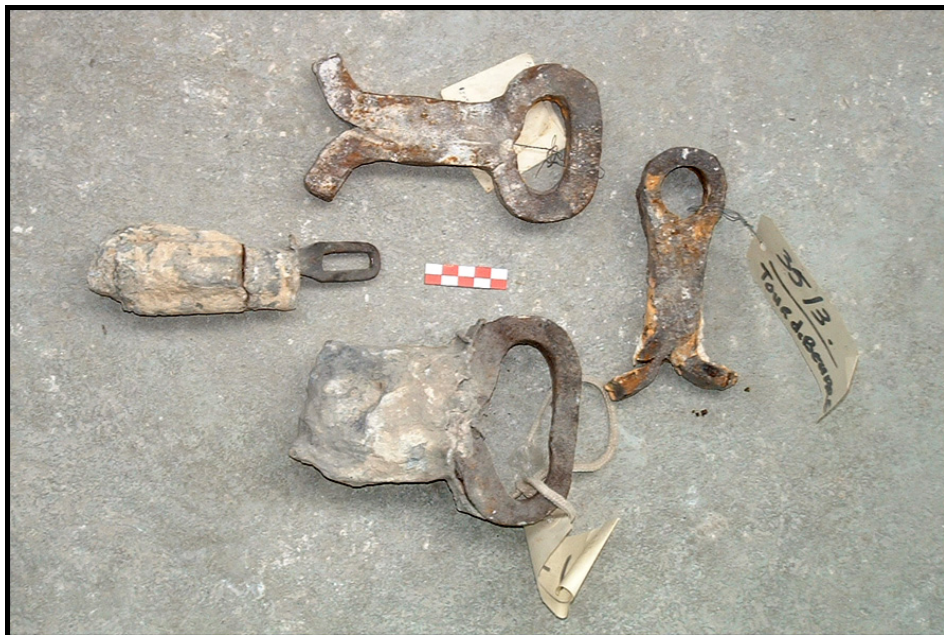
Figure 60 : Différents types d'attache de statue. En haut à gauche, barre au pied des statues du portail des Libraires. En haut à droite, crochets d'attache des statues sectionnés sur le portail des Libraires. En bas, dépôt d'attaches aux ateliers Legrand, cliché C. Colliou.
