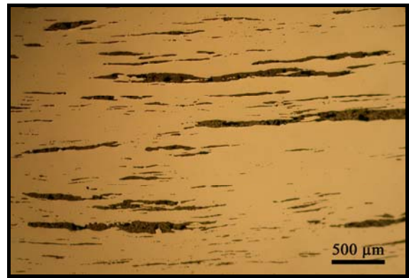
Figure 235 : Mauvaise propreté inclusionnaire, section JEAN H5a.
