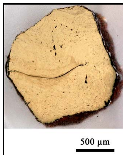
Figure 123 : Fissure due à une mauvaise soudure et alignements d'inclusions, échantillon OUEEN13b.
