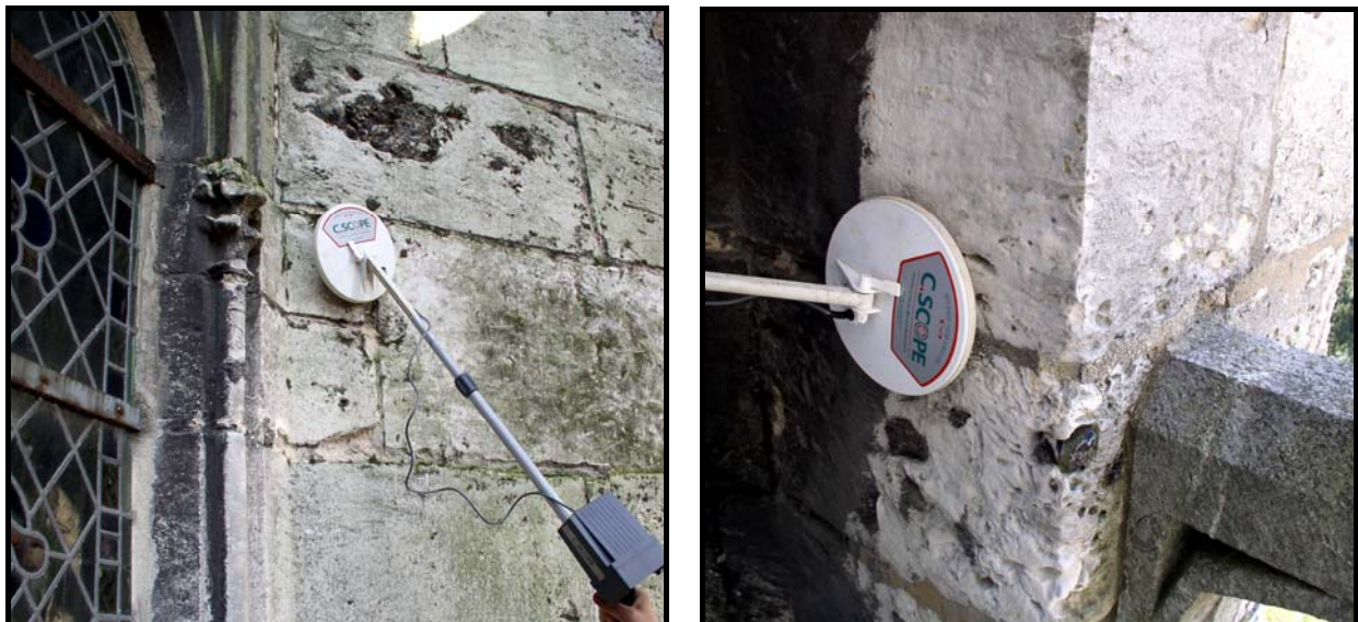
Figure 10 : Prospections au détecteur de métaux au niveau de barlotières-tirants et de balustrades, église Saint-Ouen.
