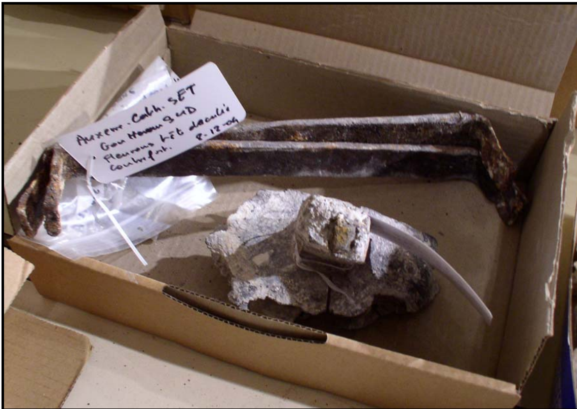
Figure 278 : Goujon et agrafes provenant d'un fleuron de la cathédrale d'Auxerre.
