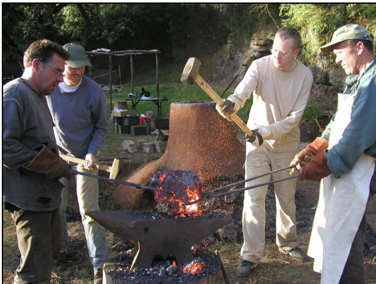
Figure 297 : Expérience de compactage de loupe. Plateforme expérimentale de Melle. P. Merluzzo, R. Aranda, L. Bellot-Gurlet, Ph. Dillmann, cliché D. Neff.
