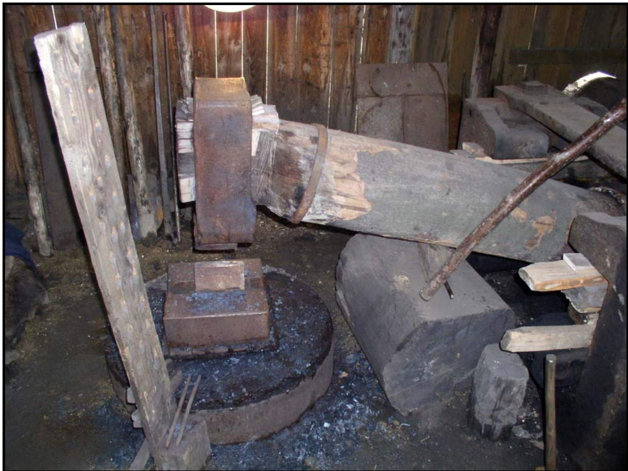
Figure 3 : Principe du marteau hydraulique d'après J. Rouillard 78 et marteau hydraulique encore en activité, forge de J. Bröstl à Medzev (Slovaquie).
