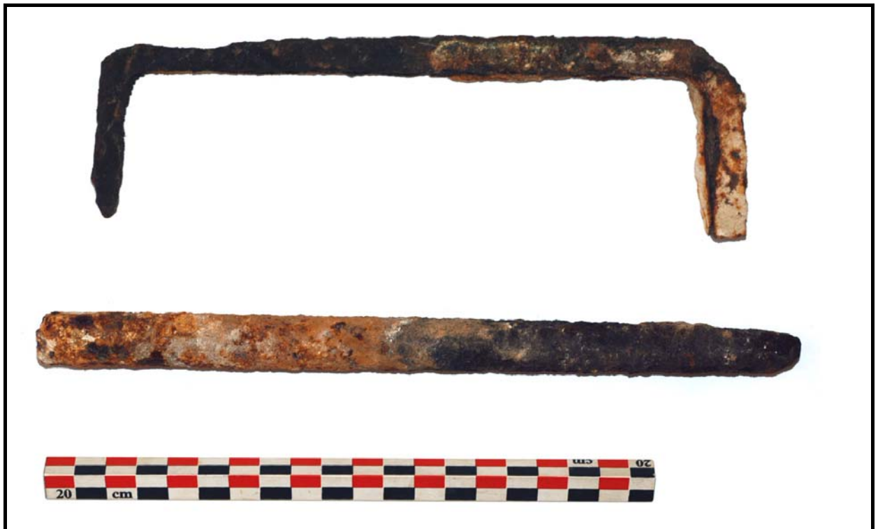
Figure 142 : Agrafe OUEN 20 et goujon OUEN 21 prélevés dans une gargouille de la nef de l'église Saint-Ouen de Rouen.
