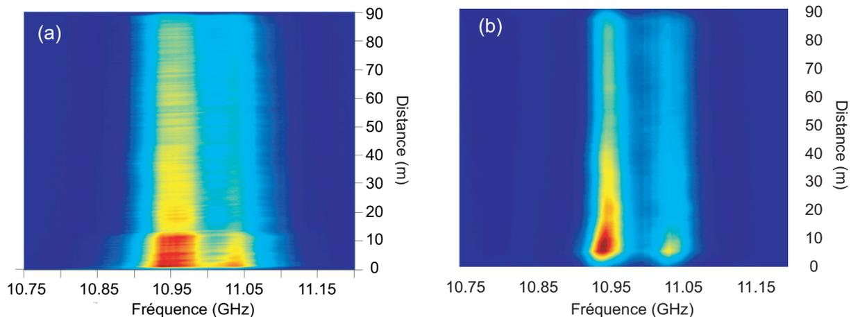
Fig. 5.7 Spectre de gain Brillouin dans la PCF<sub>8</sub> pour une durée d'impulsion pompe de (a) 20 ns et (b) 100 ns.
