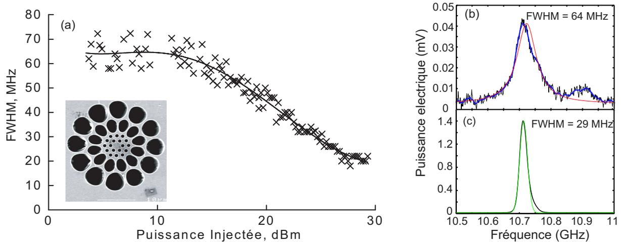
**Fig. 4.12** (a) largeur à mi-hauteur du pic principal du spectre de rétrodiffusion Brillouin en fonction de la puissance injectée dans la PCF5. Encart, image MEB de la section transverse de la PCF5. Spectre de diffusion Brillouin pour une puissance injectée par rapport au seuil Brillouin de (b) -10 dB, (c) 0 dB. Les courbes en rouge et en vert sont respectivement une Lorentzienne et une Gaussienne.
