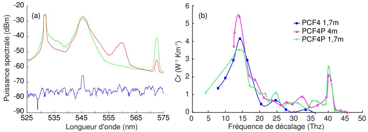
**Fig. B.7** (a), dans la fibre PCF<sub>4</sub>P de 4m, en plaçant un signal (bleu) sur le premier ordre Raman de la pompe (vert), on fait apparaître le deuxième ordre Raman sur le signal amplifié (rouge). (b), mesure du spectre de gain Raman dans trois PCF (PCF<sub>4</sub> de 1,7 m, PCF<sub>4</sub>P de 1,7 m et 4 m) avec un signal issu d'un continuum généré dans une fibre DSF.
