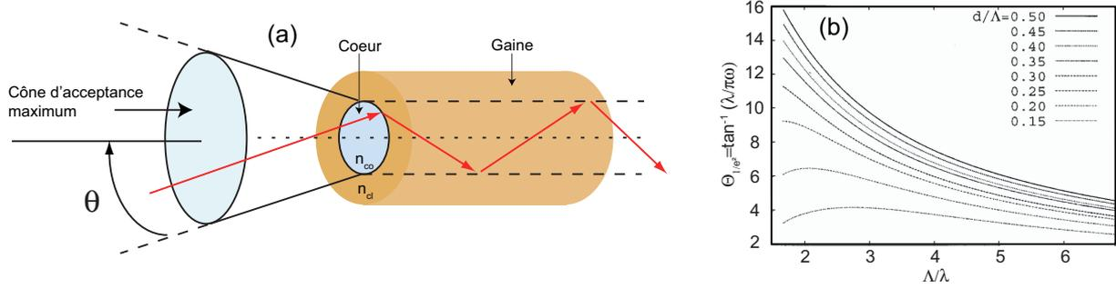
**Fig. 2.8** (a) mécanisme d'injection de la lumière dans une fibre optique. (b) calcul du demi angle de divergence en fonction de  $\Delta/\lambda$  pour différentes dimensions de microstructures d'après [34].
