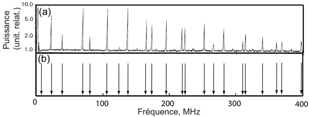
**Fig. 1.13** (a), spectre des modes GAWBS dépolarisé mesuré par Shelby *et al.* [48]. (b), les flèches marquent les fréquences théoriques des modes Torso-Radiaux calculées d'après l'équation 1.18 avec les paramètres suivants  $d_{ext} = 129 \mu m$ ,  $\alpha = 0,6203$  et  $V_L = 5996 m/s$ .
