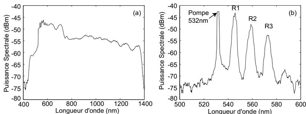
Fig. A.2 (a), génération d'un SC de 900 nm d'étendue spectrale pour une puissance d'entrée de 10 mW. (b), cascade Raman pour une puissance injectée de 2 mW.
