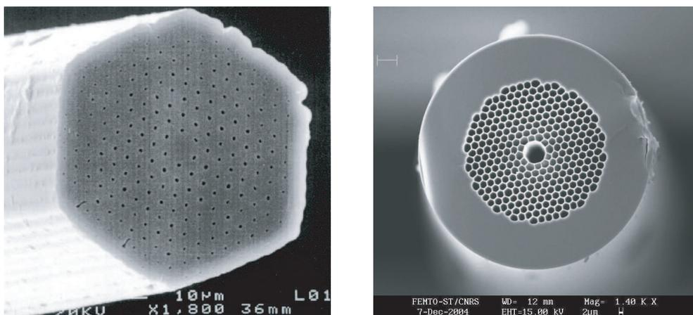
**Fig. 2.2** Images MEB de la section transverse de la première fibre photonique à cœur plein (à gauche) d'après [12] et d'une fibre à cœur creux fabriqué par Blazephotonics dont l'image a été réalisée à l'institut FEMTO-ST et (à droite).
