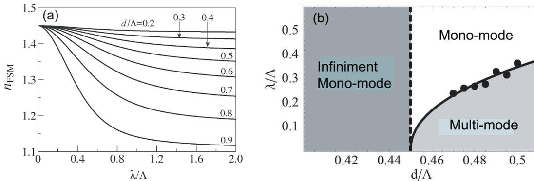
**Fig. 2.5** (a), représentation de l'indice effectif de gaine d'une PCF en fonction de  $\lambda/\Lambda$  pour des valeurs de  $d/\lambda$  variant de 0,2 à 0,9 d'après [19]. (b), représentation des trois régimes de fonctionnement d'une fibre microstructurée en fonction de  $d/\lambda$  et  $\lambda/\Lambda$ . La courbe et les ronds correspondent respectivement à  $V_{eff}=2,405$  et aux mesures d'après [20].
