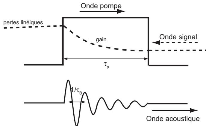
**Fig. 5.3** Représentation schématique de l'interaction entre les ondes pompe, sonde et acoustique. Les résolutions spatiales et spectrales sont déterminées par le "nombre d'interaction" entre l'onde acoustique et l'onde pompe. Plus la durée de l'impulsion pompe est courte plus la résolution spatiale est bonne au détriment de la résolution spectrale et vice versa.
