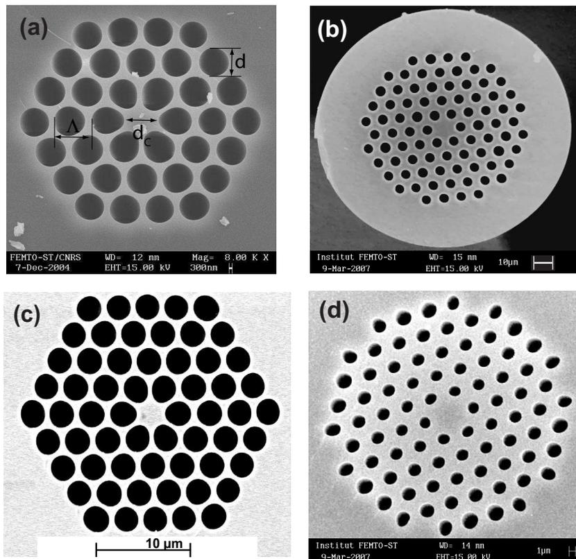
**Fig. 2.9** Images MEB réalisées à l'institut FEMTO-ST des sections transverses de quelques fibres photoniques utilisées : (a) PCF4P, (b) PCF70, (c) PCF6 et (d) PCF12.
