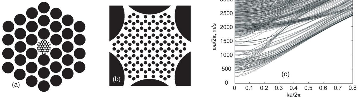
**Fig. 1.14** (a) Section de la fibre avec un cœur nanostructuré. (b) Gros plan sur la microstructuration du cœur, les trous ont un diamètre de  $187\ \text{nm}$  et ils sont séparés de  $207\ \text{nm}$ . (c) Diagramme de bande des modes de propagation élastiques dans la fibre photonique dont le cœur est représenté en (b). En noir, les trous d'air, en blanc la silice d'après [46].
