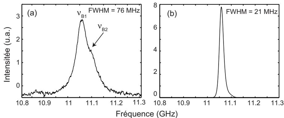
**Fig. 4.16** Spectres de diffusion Brillouin dans la fibre PCF12 pour une puissance injectée par rapport au seuil Brillouin de (a) -10 dB, (b) 0 dB. Les deux pics sont séparés de 35 MHz.
