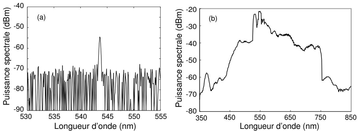
**Fig. B.5** (a), spectre du signal non amplifié à la sortie de l'amplificateur. (b), continuum de 300 nm d'étendue spectrale généré dans 2 m de fibre photonique PCF4 avec une puissance injectée de 14 mW.
