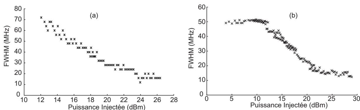
**Fig. 4.15** Largeur à mi-hauteur du pic principal du spectre Brillouin dans la fibre (a) PCF<sub>4</sub> et (b) PCF<sub>4</sub>P en fonction de la puissance injectée.
