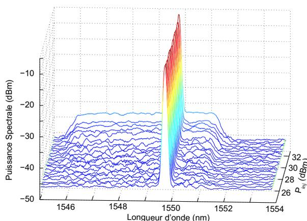
**Fig. 4.3** Spectres de la puissance pompe relevés à la sortie 2 du circulateur pour des puissances de sortie de l’EDFA variant de 500 mW à 2 W.
