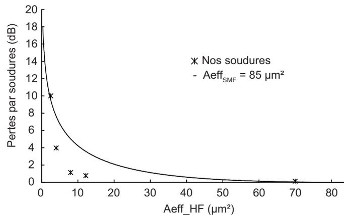
**Fig. 2.15** Evolution des pertes par soudure entre une fibre photonique et une fibre SMF possédant une aire effective de  $85 \mu\text{m}^2$  d'après l'équation 2.11. Les croix représentent la moyenne des pertes par soudure des PCF utilisés avec notre technique.
