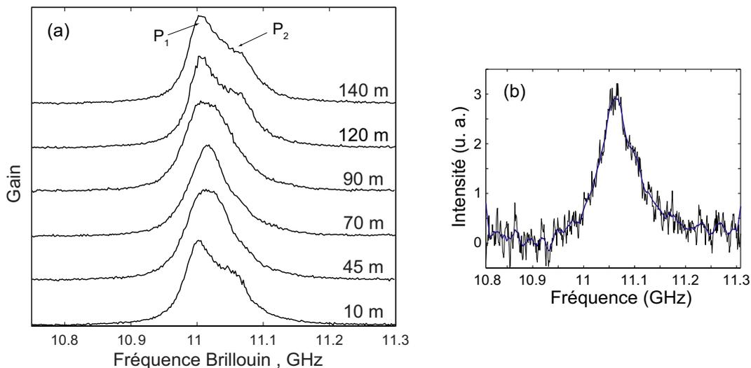
**Fig. 5.12** (a) spectres de gain Brillouin mesurés à différentes positions le long de la fibre PCF12 pour une durée d'impulsion pompe de 100ns. (b) spectre de diffusion Brillouin spontané mesuré par détection hétérodyne.
