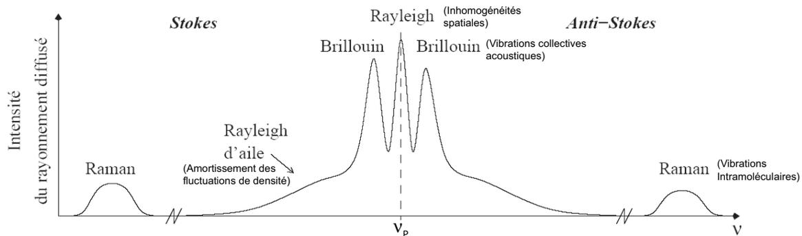
**Fig. 1.1** Allure d'un spectre de diffusion spontanée pour une fréquence d'excitation  $\nu_p$ . On observe des structures résonantes de types Raman, Brillouin et Rayleigh. (Les échelles sont arbitraires mais respectent la hiérarchie de position et d'amplitude).
