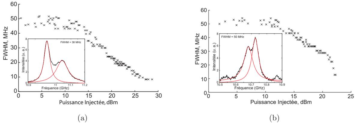
**Fig. 4.10** Largeur à mi-hauteur du pic principal du spectre de diffusion dans la fibre (a) PCF8 et (b) PCF2.5. Les encarts représentent les spectres de diffusion pour une puissance injectée cent fois plus faible que le seuil Brillouin.
