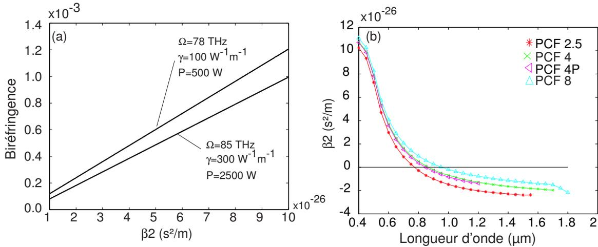
Fig. C.3 (a), représentation de la biréfringence en fonction de la dispersion. (b), Courbe de dispersion en fonction de la longueurs d'onde.
