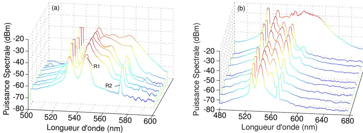
**Fig. B.1** Spectres de diffusion Raman stimulée enregistrés à la sortie d'une fibre PCF4P de longueur 1,7 m à gauche, et de longueur 4 m à droite, pour une puissance injectée variant de 2 à 6 mW (à gauche) et de moins d'1 mW à 3 mW (à droite).
