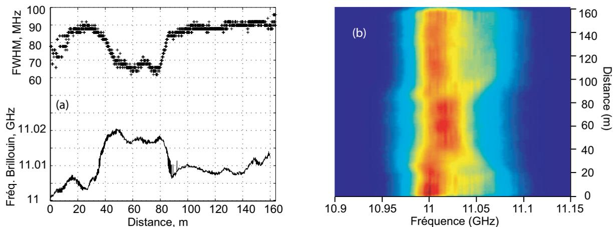
Fig. 5.11 (a) fréquence Brillouin et largeur à mi-hauteur du spectre total en fonction de la longueur de la fibre pour une impulsion pompe de 100 ns ( $\sim 10$  m de résolution). (b) évolution du spectre Brillouin le long de la PCF12.
