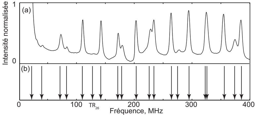
**Fig. 3.7** (a), spectre GAWBS dépolarisé dans une HNLF. (b), les flèches marquent les fréquences des modes de résonance, solutions de l'équation 1.18 avec les paramètres suivant  $\alpha = 0.6248$  et  $V_L = 6050\text{m/s}$ . La vitesse plus élevée que dans une fibre SMF-28 est due au dopage germanium .
