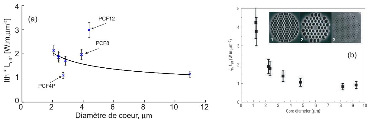
Fig. 4.5 (a) Intensité du seuil Brillouin en fonction du diamètre de cœur des fibres photoniques. Les croix représentent les mesures. La courbe ne tient pas compte des points représentant le seuil dans les fibres PCF4P, PCF8 et PCF12. (b) résultats obtenu par Dainese *et al.* [5]. Les carrés sont les résultats expérimentaux obtenus dans les fibres dont les images des sections transverses sont représentées dans les encarts.
