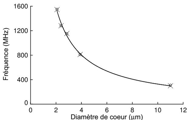
**Fig. 3.12** *Fréquence du mode acoustique confiné en fonction du diamètre de cœur de la fibre microstructurée. Les croix et les cercles représentent respectivement les mesures et les calculs par élément finis.*
