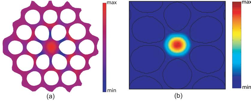
**Fig. 3.13** (a) calcul du mode élastique confiné dans le cœur de la PCF8 à la fréquence de 810 MHz. (b) calcul du mode optique fondamental à la longueur d'onde de 1550 nm. Les maxima d'énergie apparaissent en rouge.
