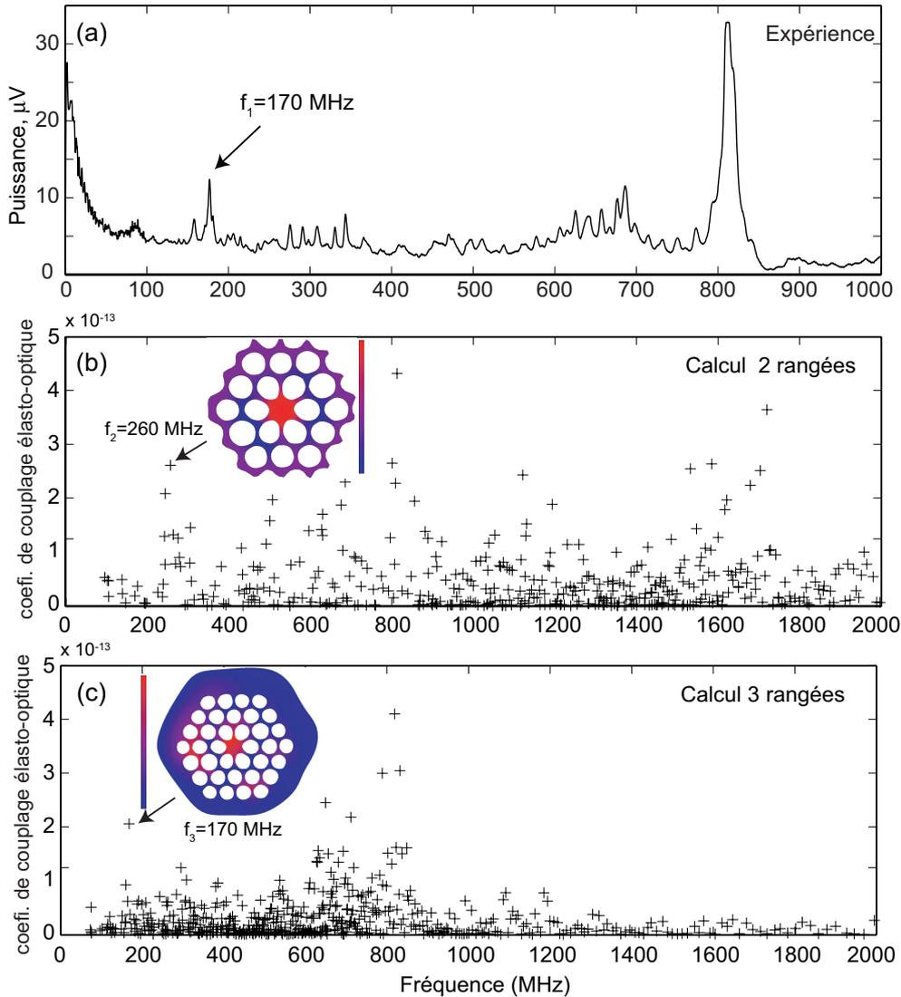
**Fig. 3.17** (a) Spectre expérimental de diffusion Brillouin de gaine polarisé dans la PCF8. Calcul du coefficient de couplage élasto-optique avec les modes acoustiques calculé dans la PCF2.5 avec une structure maillé avec (b) deux et (c) trois rangées. Encart, distribution de l'énergie suivant la fenêtre de calcul pour les modes élastiques aux fréquences de 260 MHz et 170 MHz.
