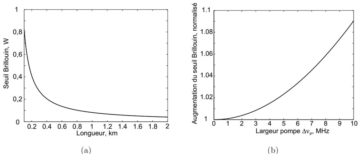
**Fig. 1.10** (a) *Seuil Brillouin en fonction de la distance dans le cas d'une fibre monomode possédant une aire effective de  $75 \mu\text{m}^2$  et des pertes linéiques de  $0,2 \text{ dB/km}$ .* (b) *Influence de la largeur spectrale de la pompe sur le seuil Brillouin dans le cas de deux faisceaux Gaussien.*
