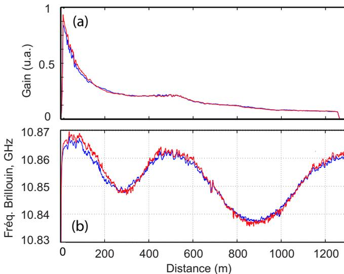
**Fig. 5.16** (a) gain maximum et (b) fréquence Brillouin du pic principal en fonction de la distance pour deux axes de polarisation orientés à  $90^\circ$  l'un par rapport à l'autre dans la PCF6.
