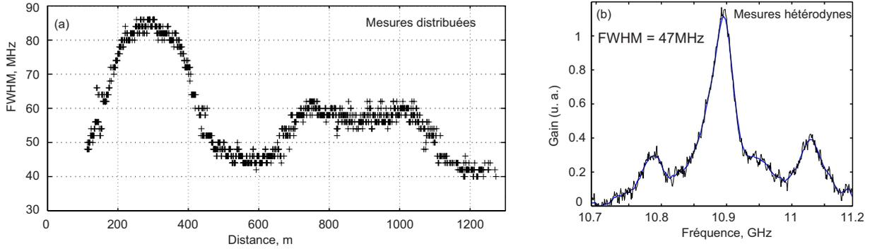
**Fig. 5.15** (a) FWHM du pic principal de la courbe de gain Brillouin en fonction de la distance dans la PCF6. (b) spectre de rétrodiffusion Brillouin pour une puissance injectée inférieure à 15 dB par rapport au seuil Brillouin.
