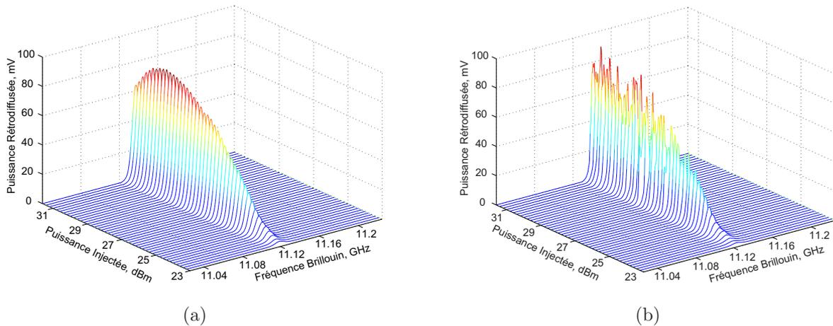
**Fig. 4.13** Evolution du spectre de diffusion Brillouin dans la PCF70 pour la même puissance injectée lorsque l'extrémité de la fibre est placée : (a) dans un liquide adaptateur d'indice et (b) dans l'air.
