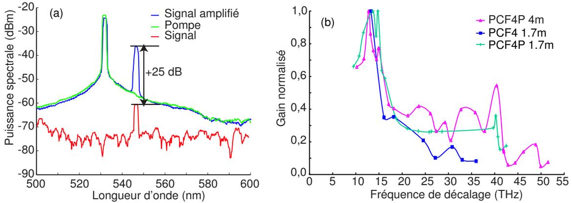
**Fig. B.6** (a), spectre de la pompe, du signal à 446 nm et du signal amplifié de 25 dB dans la fibre PCF<sub>4</sub> de 1,7 m. (b), spectre de gain Raman dans trois fibres photoniques avec un signal issu d'un continuum généré dans la PCF<sub>4</sub>.
