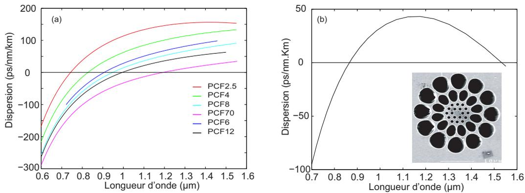
**Fig. 2.11** (a) Courbes de dispersion chromatique en fonction de la longueur d'onde obtenue avec le logiciel MODES dans les fibres microstructurées constitué d'un cœur de silice. (b), Courbe de dispersion dans la PCF5 qui présente deux longueurs d'ondes de dispersion nulle. Encart, image MEB de la section transverse de la PCF5.
