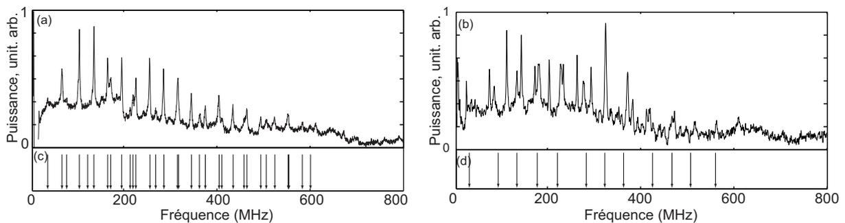
**Fig. 3.9** Spectres des modes de gaines  $TR_{2m}$  (a) et  $R_{0m}$  (b) issus d'une SMF. (c-d) calcul des modes de gaines jusqu'à 600 MHz d'après les équations 1.18 1.17 présentées dans le chapitre 1 avec  $d_{ext} = 125 \mu m$ ,  $\alpha = 0,627$  et  $V_L = 6050 m/s$ .
