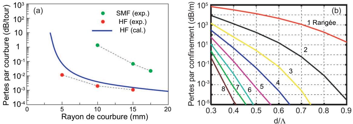
**Fig. 2.6** (a), pertes par courbures en fonction du rayon de courbure d'une fibre photonique (HF) et d'une fibre standard (SMF) d'après [25]. (b), calcul des pertes par confinement en fonction du rapport  $d/\Lambda$  pour un nombre de rangées de trous variant de 1 à 8 d'après [26].
