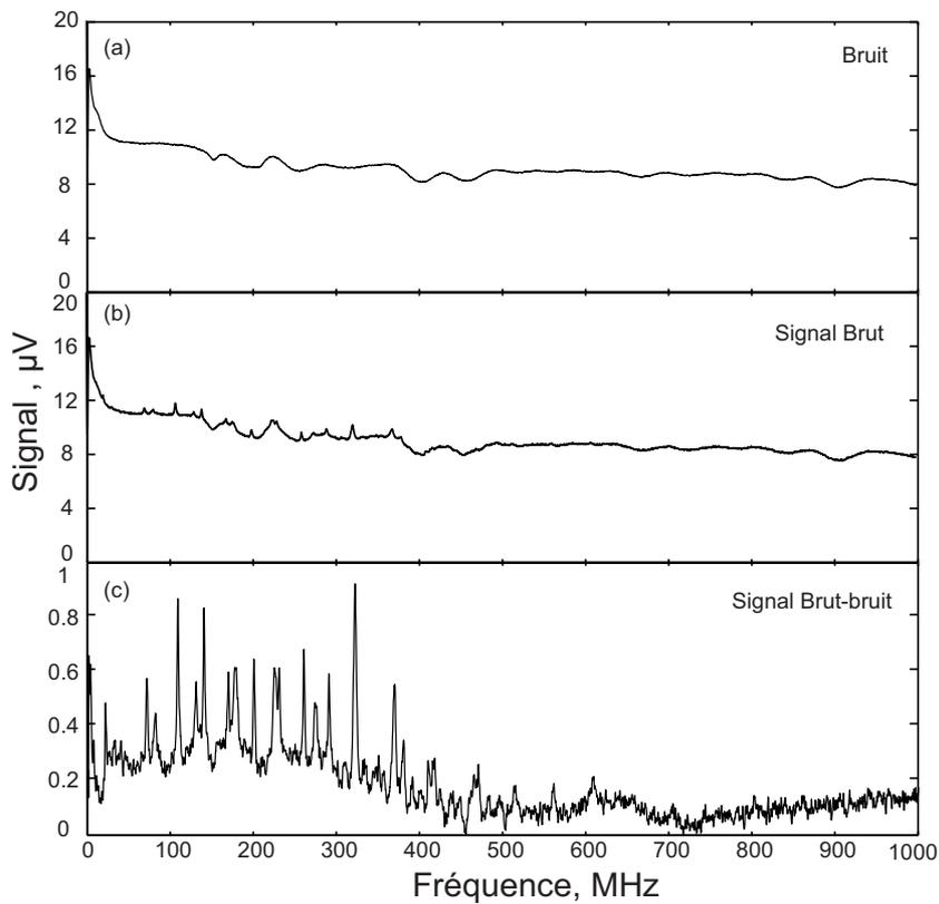
**Fig. 3.8** (a) Spectre de bruit lissé introduit par l'amplificateur RF, la photodiode et l'analyseur de spectre électrique. (b) Spectre de diffusion Brillouin de gaine dans un très court tronçon de fibre standard tel qu'il est relevé sur l'analyseur de spectre. (c) Même spectre que précédemment sans le spectre de bruit représenté en (a).
