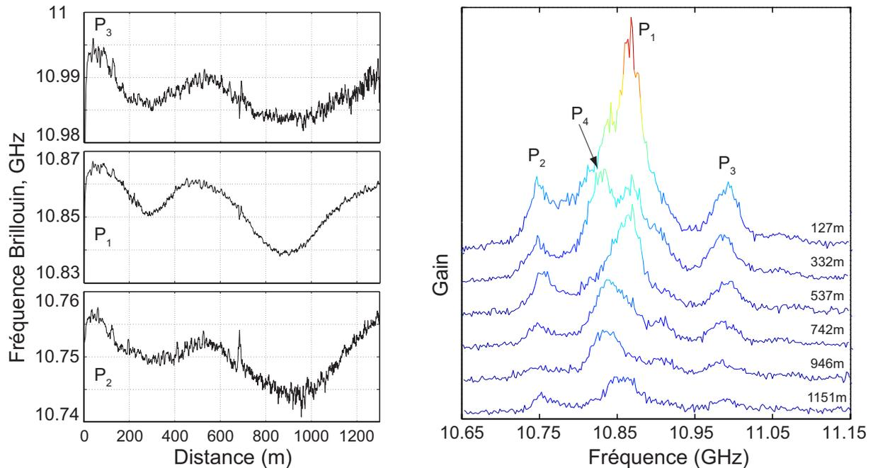
**Fig. 5.14** A gauche, fréquence des trois pics constituant le spectre de gain Brillouin en fonction de la longueur de la fibre PCF6. A droite, spectres Brillouin à différentes positions dans la fibre PCF6.
