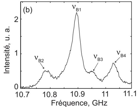
**Fig. 4.17** (a) calcul des fréquences Brillouin à partir des indices effectifs des modes optiques d'ordre supérieur LP11s dans la PCF6 avec  $v_a = 5960$  m/s. (b) spectre de diffusion pour une puissance injectée cent fois plus faible que le seuil Brillouin dans la PCF6. Nous observons clairement quatre pics aux fréquences  $\nu_{B1} = 10,893$  GHz,  $\nu_{B2} = 10,785$  GHz,  $\nu_{B3} = 10,95$  GHz,  $\nu_{B4} = 11,028$  GHz.
