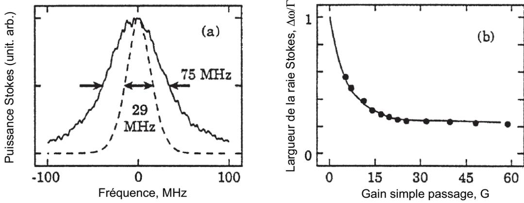
**Fig. 1.9** (a) Spectre du champ Stokes spontané pour une faible pompe (trait plein) et stimulé pour une forte pompe (trait pointillé) pour une longueur d'onde de pompe de 570 nm. (b) Dépendance de la largeur du champ Stokes en fonction du gain simple passage  $G$ . La courbe est la prédiction théorique, et les point noirs sont les résultats expérimentaux d'après [22].
