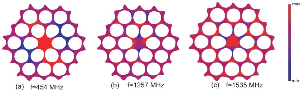
**Fig. 3.15** Distribution de l'énergie cinétique pour les modes acoustiques de la PCF2.5 de fréquence (a) 454 MHz, (b) 1257 MHz et (c) 1535 MHz. Ces trois modes donnent les plus forts coefficients élasto-optique. Les maximas d'énergie apparaissent en rouge sur la figure.
