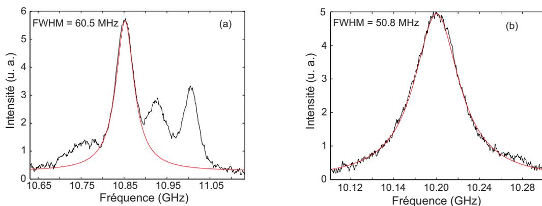
**Fig. 4.14** Spectres de diffusion Brillouin pour une puissance injectée cent fois plus faible que le seuil Brillouin dans la fibre (a) PCF<sub>4</sub> et (b) PCF<sub>4</sub>P. En rouge, superposition d'une Lorentzienne.
