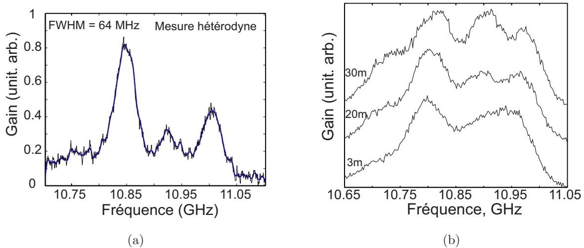
Fig. 5.6 Spectre de diffusion Brillouin obtenu par (a) détection hétérodyne et (b) mesures distribuées de la CGB dans la PCF<sub>4</sub>.
