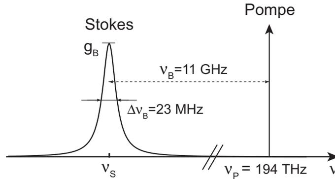
**Fig. 1.8** Diffusion Brillouin spontanée dans une fibre optique de type SMF28 à la longueur d'onde de pompe de 1550 nm. Représentation schématique des champs impliqués et des fréquences mise en jeu.
