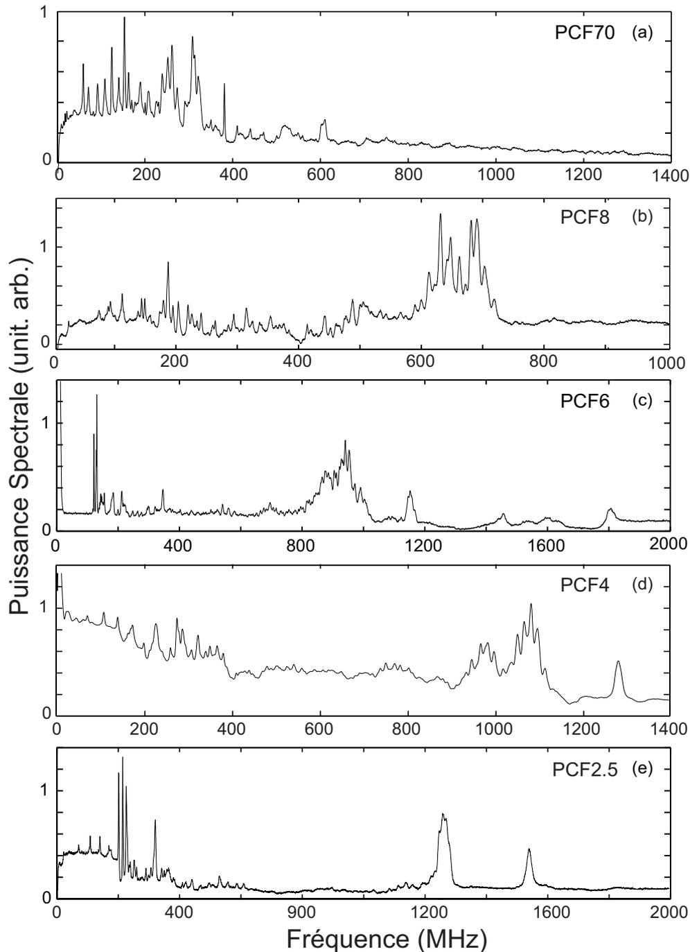
**Fig. 3.10** Spectres de diffusion Brillouin de gaine dépolarisée dans cinq fibres photoniques. La résolution spectrale est de 300 kHz.
