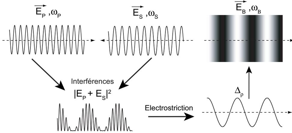
**Fig. 1.7** *Processus de diffusion Brillouin stimulée. A la résonance, le battement entre l'onde pompe  $E_P$  et l'onde Stokes  $E_S$  crée par électrostriction une onde élastique  $\Delta_p$  qui diffuse l'onde pompe et par conséquent renforce l'onde Stokes.*
