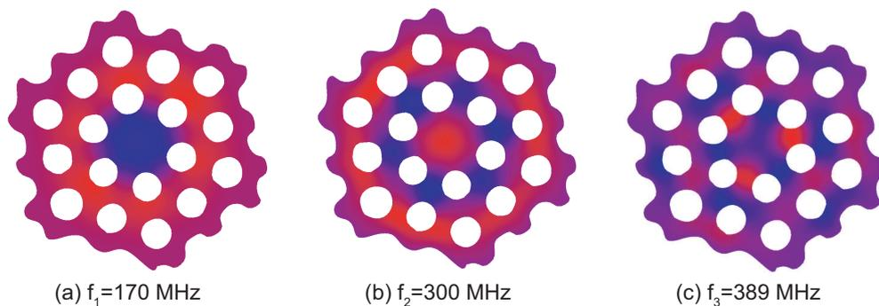
**Fig. 3.19** Distribution de l'énergie élastique pour les modes acoustiques de la PCF70 qui donnent le meilleur couplage élasto-optique aux fréquences de (a) 170 MHz, (b) 300 MHz, (c) 389 MHz. Les maxima et minima d'énergie apparaissent respectivement en rouge et en bleu sur la figure.
