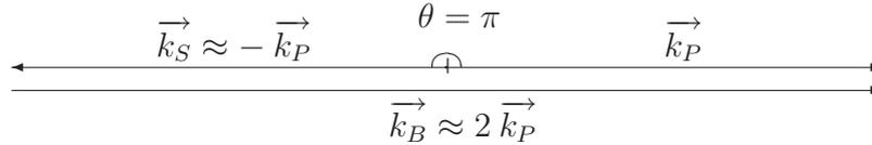
**Fig. 1.6** Représentation des vecteurs d'onde lors d'un processus de diffusion Brillouin stimulée dans une fibre optique unimodale. Le vecteur d'onde acoustique est pratiquement égal au double de celui de la pompe.
