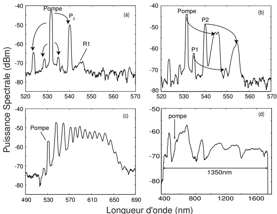
**Fig. A.4** Spectres de sortie de la fibre PCF<sub>4</sub> pour une puissance de pompe croissante. (a) processus paramétriques, (b) double diffusion Raman stimulée, (c) cascade Raman ( $P = 1$  mW), (d) SC de 1350 nm pour une puissance moyenne injectée de 20 mW.
