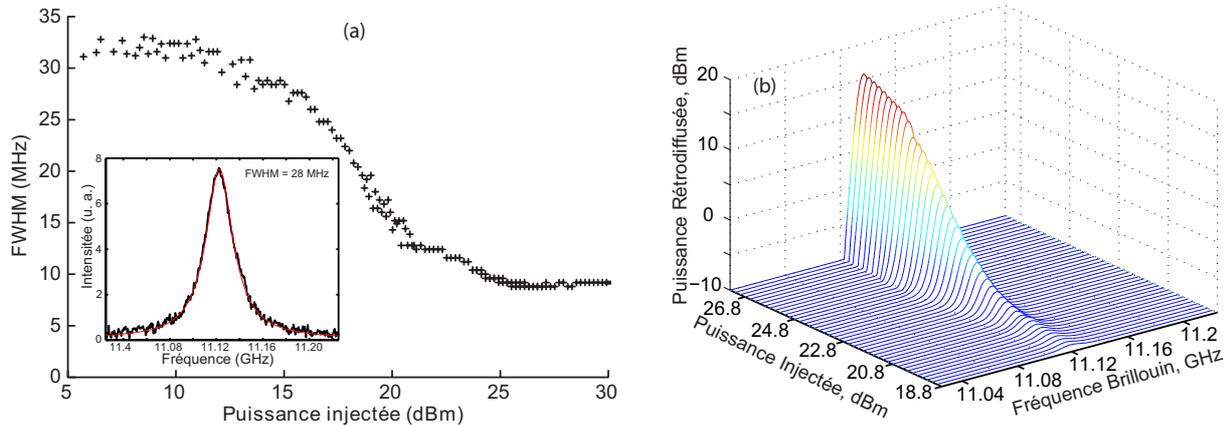
**Fig. 4.11** (a) largeur à mi-hauteur du spectre de rétrodiffusion Brillouin en fonction de la puissance injectée dans la PCF70. Encarts, spectre de diffusion pour une puissance injectée de 14,2 dBm et images MEB de la section transverse. En rouge, superposition d'une Lorentzienne avec les mêmes paramètres que la courbe expérimentale. (b) évolution du spectre Brillouin pour une puissance injectée variant de 75 mW à 500 mW.
