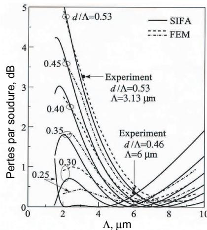
**Fig. 2.12** Pertes par soudure entre une fibre toute silice et une PCF en fonction de l'écart entre les trous à la longueur d'onde de 1550 nm, d'après [53]. FEM, méthode par éléments finis, SIFA, approximation avec une fibre à saut d'indice.
