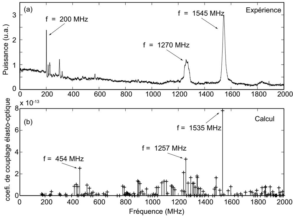
**Fig. 3.14** (a) Spectre expérimental de diffusion Brillouin de gaine polarisée. (b), coefficient de diffusion élasto-optiques entre le mode optique fondamental à 1550 nm et les modes acoustiques générés entre 0 et 2 GHz dans la PCF2.5.
