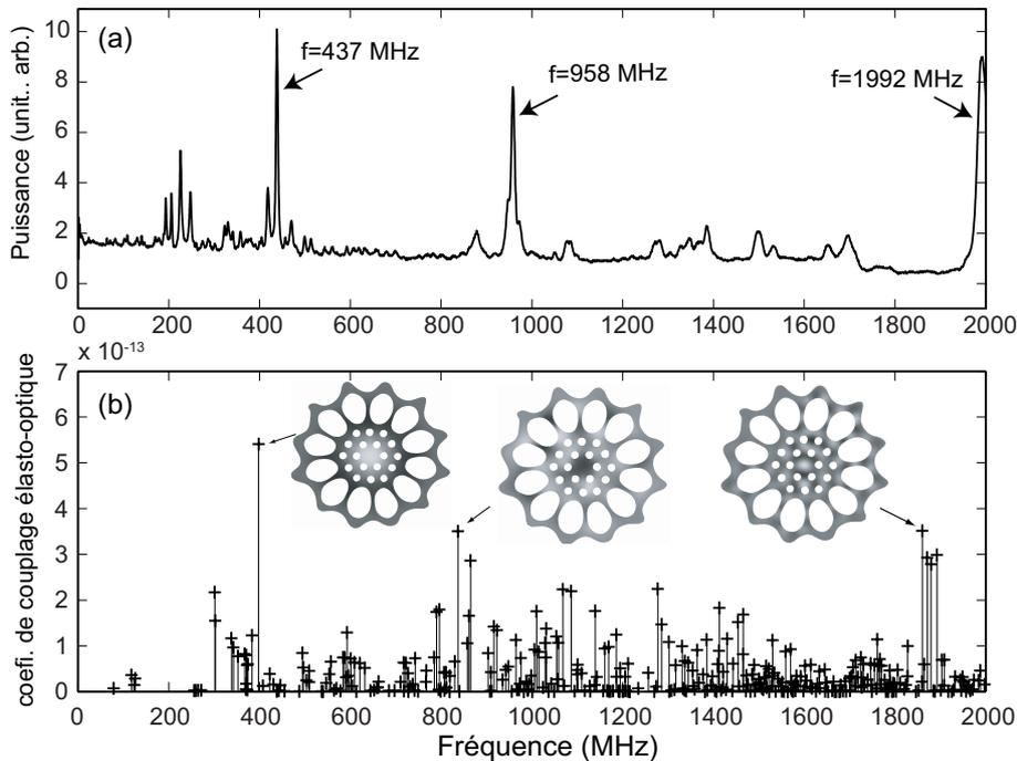
**Fig. 3.20** (a), spectre de diffusion Brillouin de gaine polarisée et (b), calcul du coefficient élasto-optique dans la fibre PCF5. Encart, répartition de l'énergie des modes élastiques les plus intenses déterminée par éléments finis aux fréquences 398 MHz, 837 MHz et 1860 MHz.
