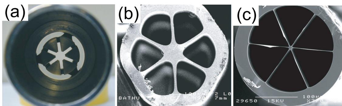
**Fig. 2.4** (a), image d'une filière utilisée pour fabriquer une fibre par extrusion. (b), image de la préforme obtenu d'un diamètre extérieur de 1 mm. (c), image de la section de la fibre après étirage, d'après [16].
