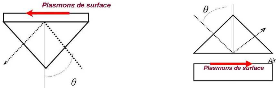
Figure I-3 : représentation des deux méthodes dites ATR ( Attenuated Total Reflexion ): à gauche, configuration de Kretschmann-Raether , à droite, configuration d' Otto .
