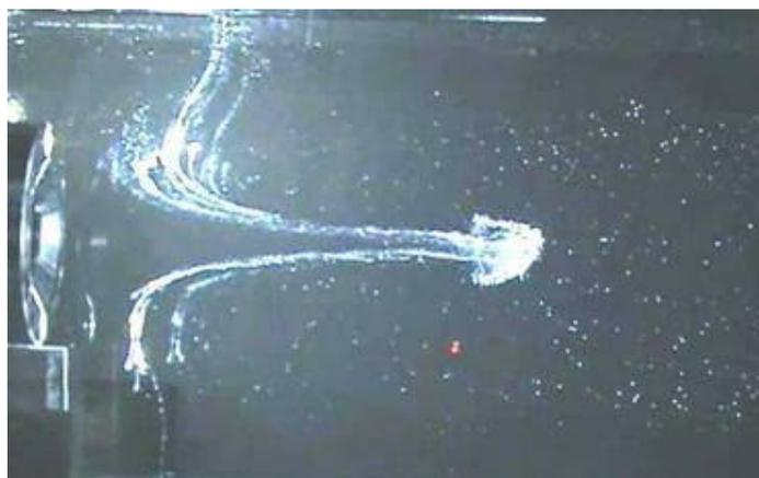
Figure 3.1 : Mise en évidence par P.I.V. (Particle Image Velocimetry) du « streaming » acoustique induit par une onde de fréquence  $f_0 = 800$  kHz se propageant dans le Glycérol. La photo correspond à l'état transitoire. (Depuis [http://www.lmfa.ec-lyon.fr/perso/Valery.Botton/acoustic\\_streaming\\_bis.html](http://www.lmfa.ec-lyon.fr/perso/Valery.Botton/acoustic_streaming_bis.html))
