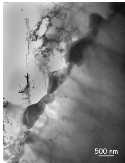
Figure A.4 : Carbures M_{23}C_6 au joint de grains de l'alliage après un maintien à 900°C pendant 25 h sous He impur.
