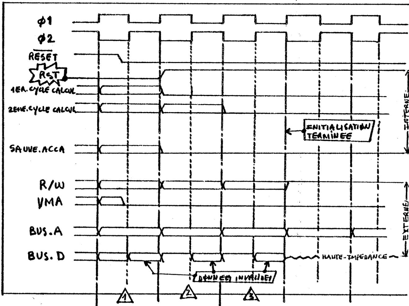
FIG. 45 - Diagramme des temps de la séquence d'initialisation.
