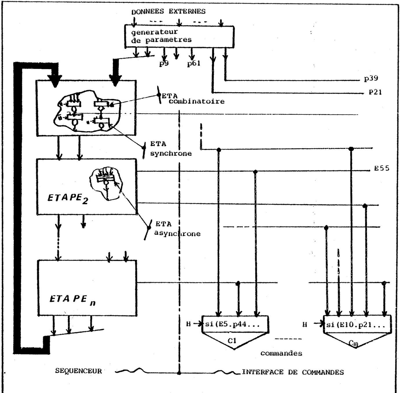
FIG.20 Description DELTA de l'architecture générale d'une partie controle à structure câblée (model de Mealy).
