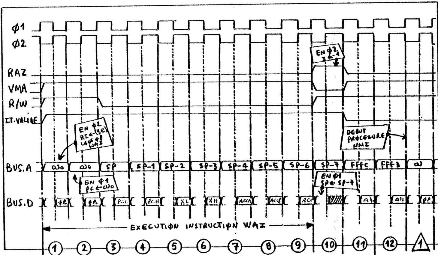
FIG. 53 - Diagramme des temps du signal NMI.
