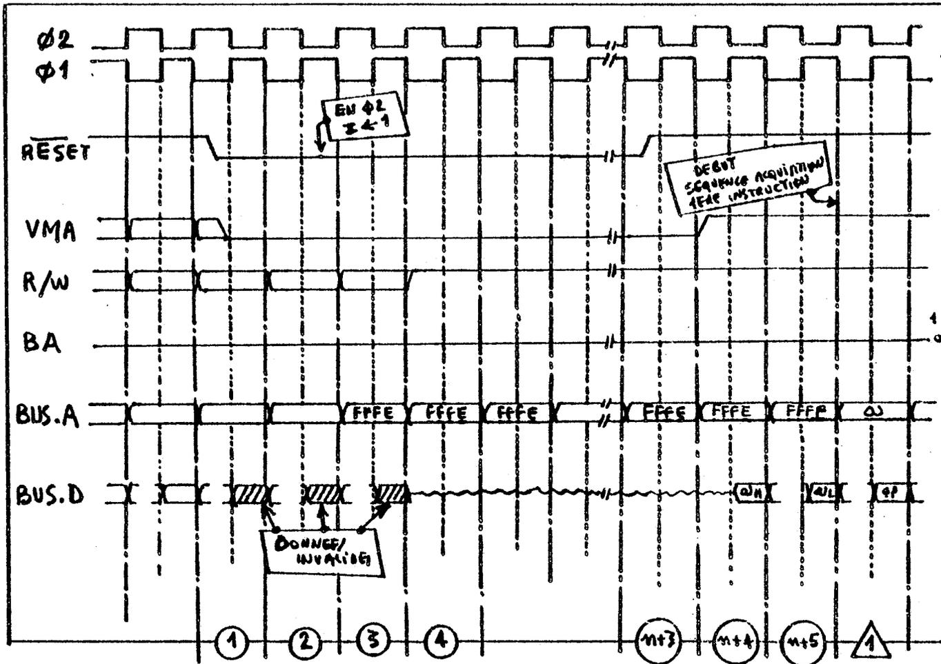
FIG. 49 - Diagramme des temps du signal RESET
