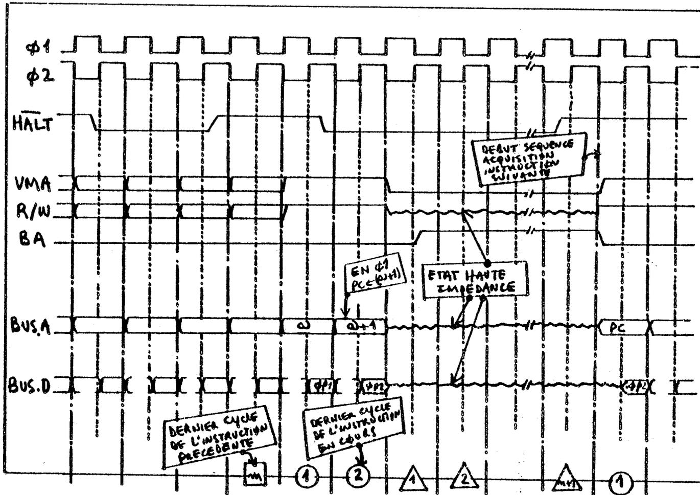
FIG. 51 - Diagramme des temps du signal  $\overline{\text{HALT}}$ .
