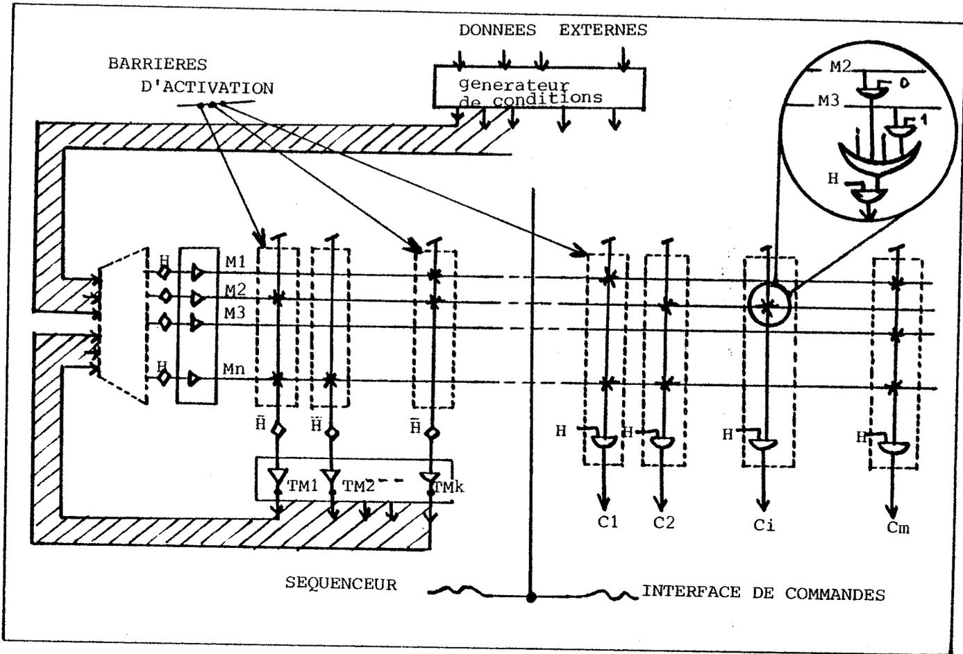
fig. 25 : structure générale d'une partie contrôle micro-programmée
