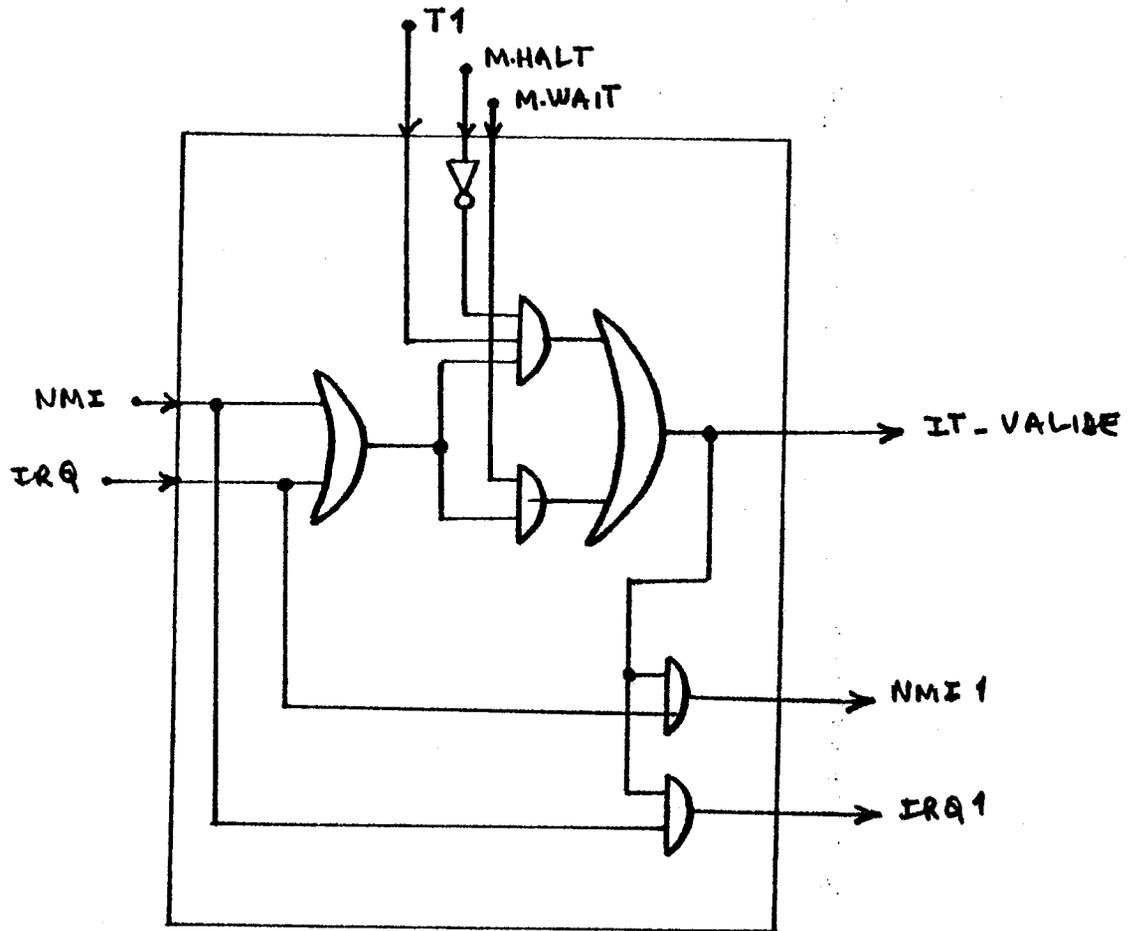
FIG. 47 - Circuit de validation des interruptions (NMI,IRQ)
