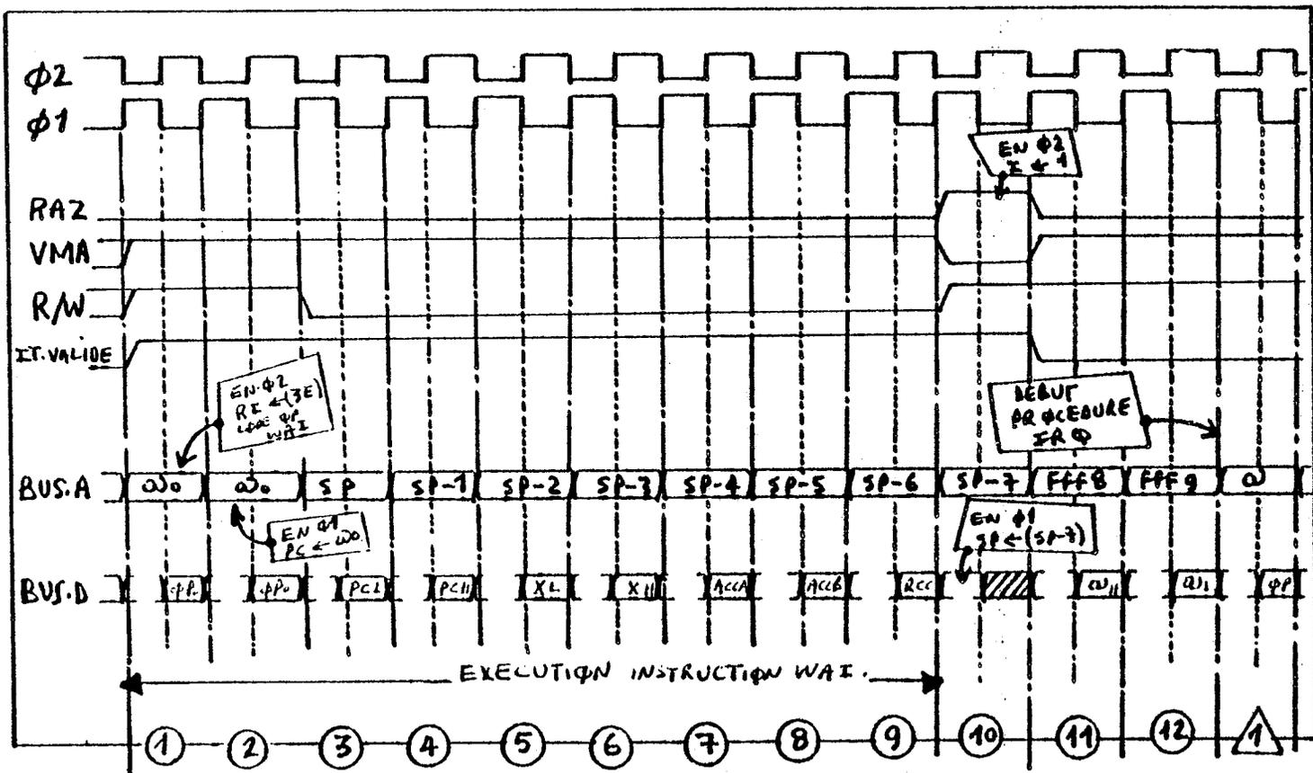
FIG. 55 - Diagramme des temps du signal IRQ.
