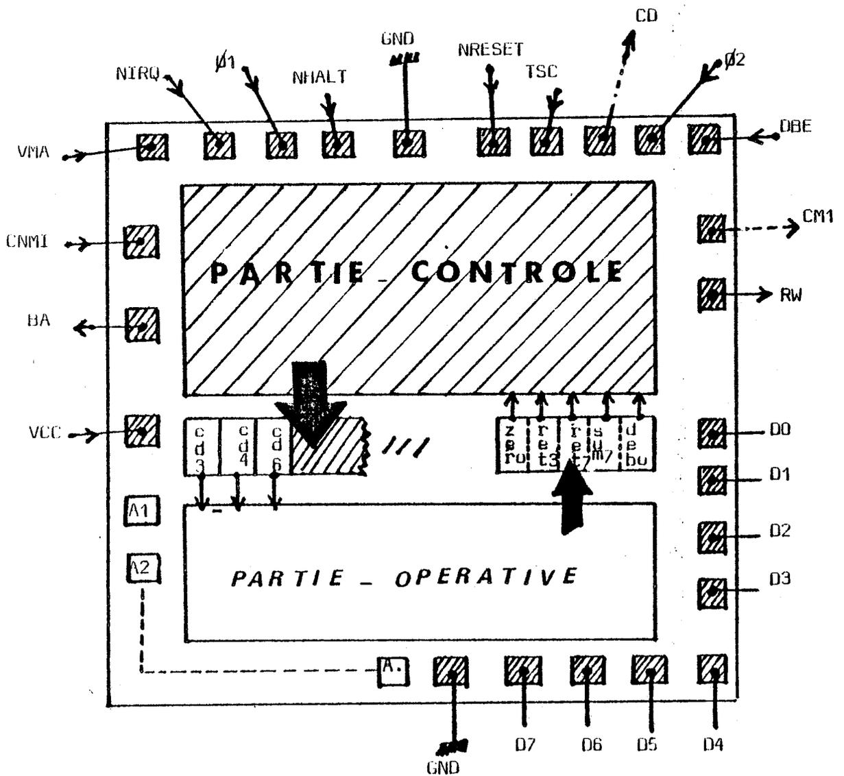
Fig. 67 Représentation des commandes externes à la partie contrôle
