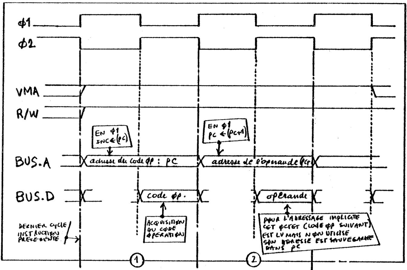
FIG. 68 - Diagramme des temps de la séquence ACQUISITION.
