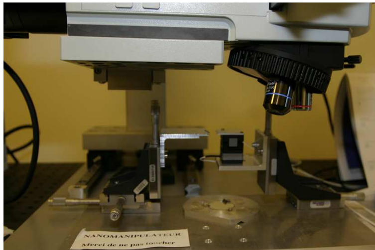
FIG. VIII.10 – Platine de micromanipulation sous microscope optique développée pour le collage de bille. On aperçoit deux platines de microcontrôle. Sur l'une d'entre elle sont montés deux actionneurs piézoélectriques (XY et Z). Le système est disposé sous un microscope dont l'optique permet une manipulation facile des échantillons.
