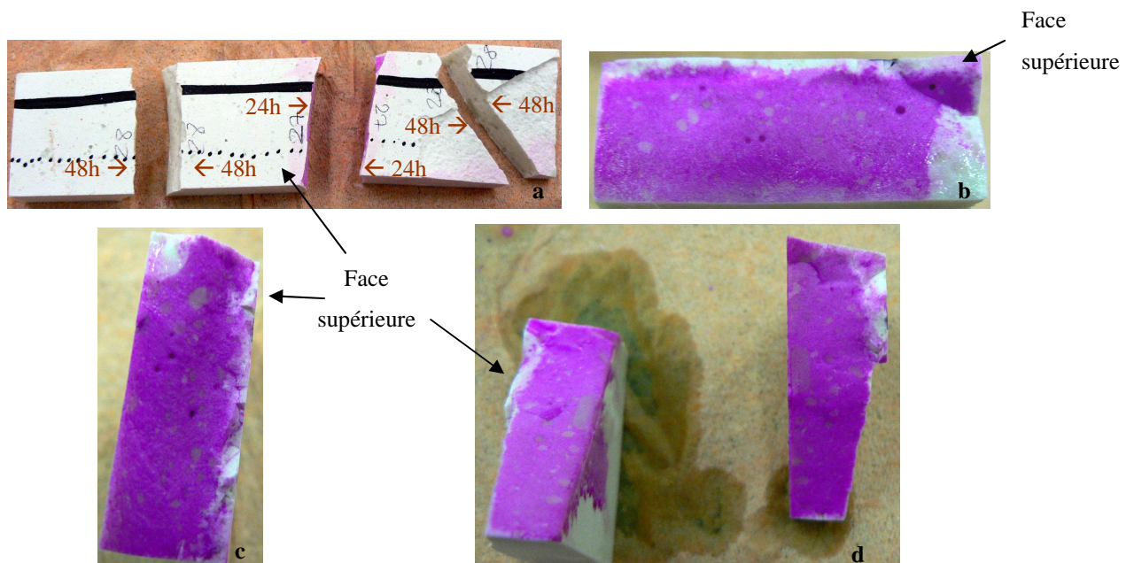
Photo 5 : Résultats obtenus pour une éprouvette 1x2,5x8,5 cm conservée 100%HR, non séchée - a. localisation des morceaux observés sur l'éprouvette – b. coloration après 24 h de carbonatation – c. coloration après 48h de carbonatation – d. coloration après 48h de carbonatation
