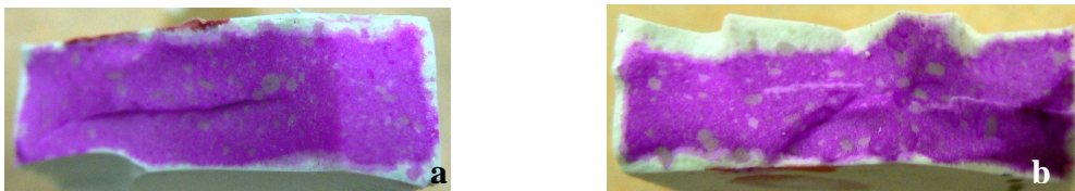
Photo 4 : Résultats obtenus pour une éprouvette 1x2,5x8,5 cm conservée sous eau, séchée – a. coloration après 24 h de carbonatation – b. coloration après 48h de carbonatation
