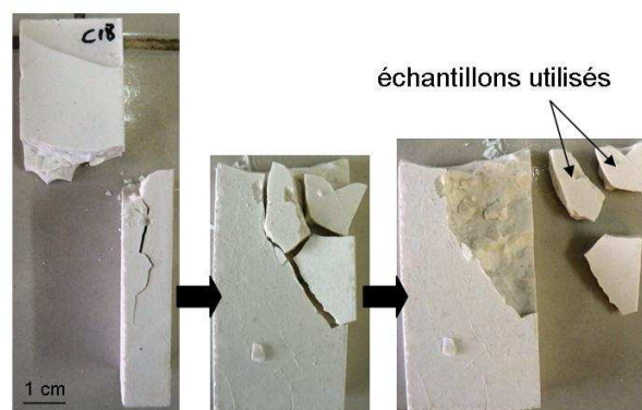
Figure 18 : échantillonnage des éprouvettes pour la coloration PAS
